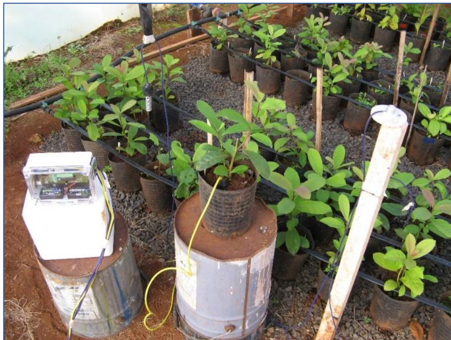
Figura 7. Data logger instalado en el ensayo midiendo variables ambientales (Temperatura ambiente, humedad relativa, radiación fotosintéticamente activa y contenido hídrico de suelo).
