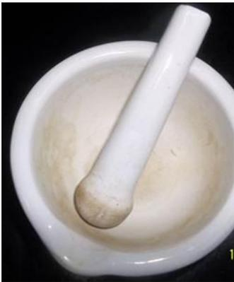
Figura 6. Detalle de mortero, para triturar las hojas de Stevia.
