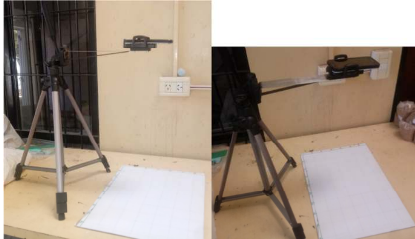
Fig. 3. Dispositivo para capturar las imágenes de los capítulos de girasol.
