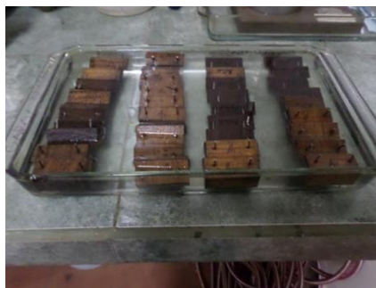
Figura 5.3 Saturación de probetas para evaluación de hinchamiento
