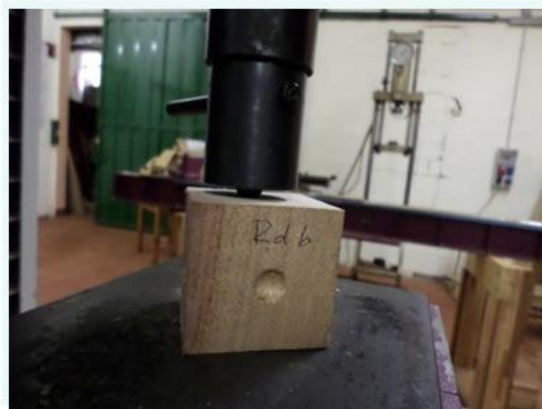
Figura 5.4. Fotografía de una probeta para evaluación de dureza Janka
