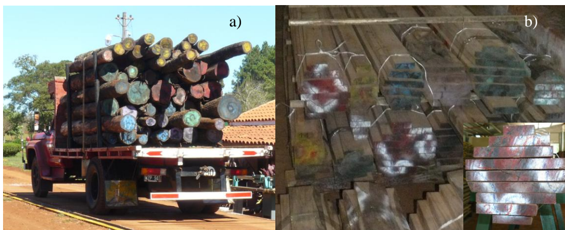
Figura 6.1. Fotografía mostrando detalle de: a) trozas aserradas, b) piezas aserradas con marcación de trazabilidad.
