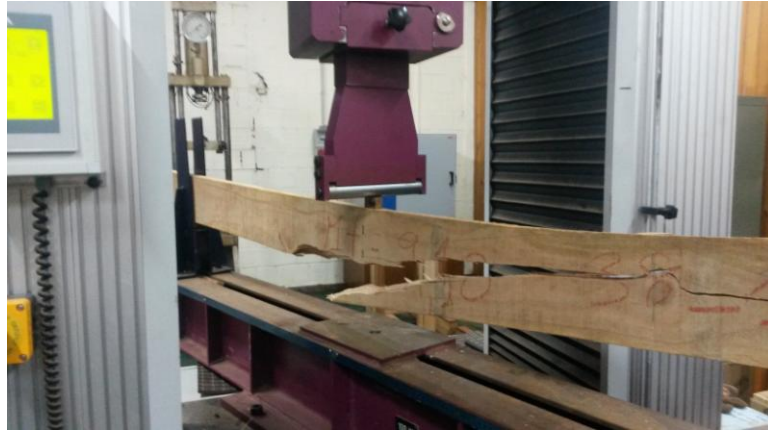
Figura 5.6. Fotografía que muestra la determinación del módulo de elasticidad mediante el uso de una máquina universal de ensayos
