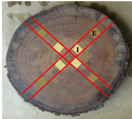
Figura 5.1. Localización probetas de posición interna (I), color ocre; probetas de posición externa (E), color marrón
