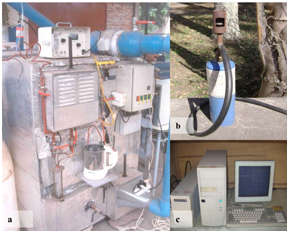
Figura 3.6. Cámara de fumigación: a) cámara de fumigación experimental, b) lámpara de haluro, c) computadora de registro de temperaturas, tiempo de fumigación y dosis de bromuro de metilo.
