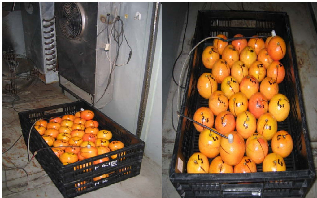
Figura 3.7. Disposición de los frutos en la cámara de fumigación en las pruebas de sensibilidad
