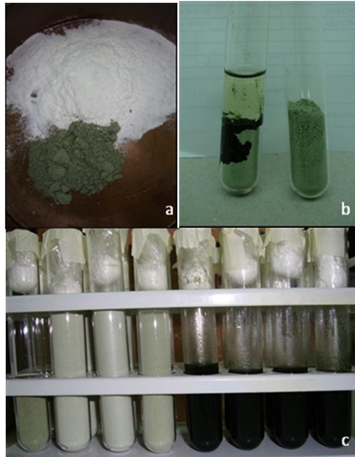
Fig. 20: Formulación de la cepa Ma 72 de Metarhizium anisopliae : a) Polvo Mojable (PM): Pre-mezcla de polvo de M. anisopliae más inerte; b) Concentrado Emulsionable (CE): Pre-mezcla de polvo M. anisopliae más oleo y coadyuvantes; c) Formulaciones terminadas
