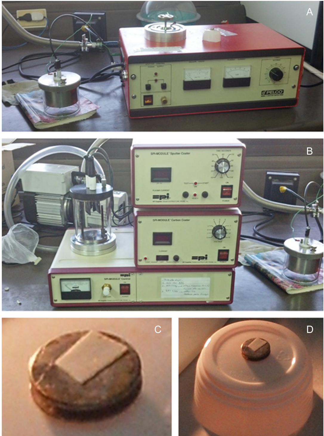
Figura 11. Metalización. A, B. Equipo metalizador. C, D. “Stubs”, tacos porta muestras; el rectángulo blanco, sobre la parte superior del taco, es la cinta doble faz que contiene los ácaros. (Imagen A-D: Sergio Leiva).
