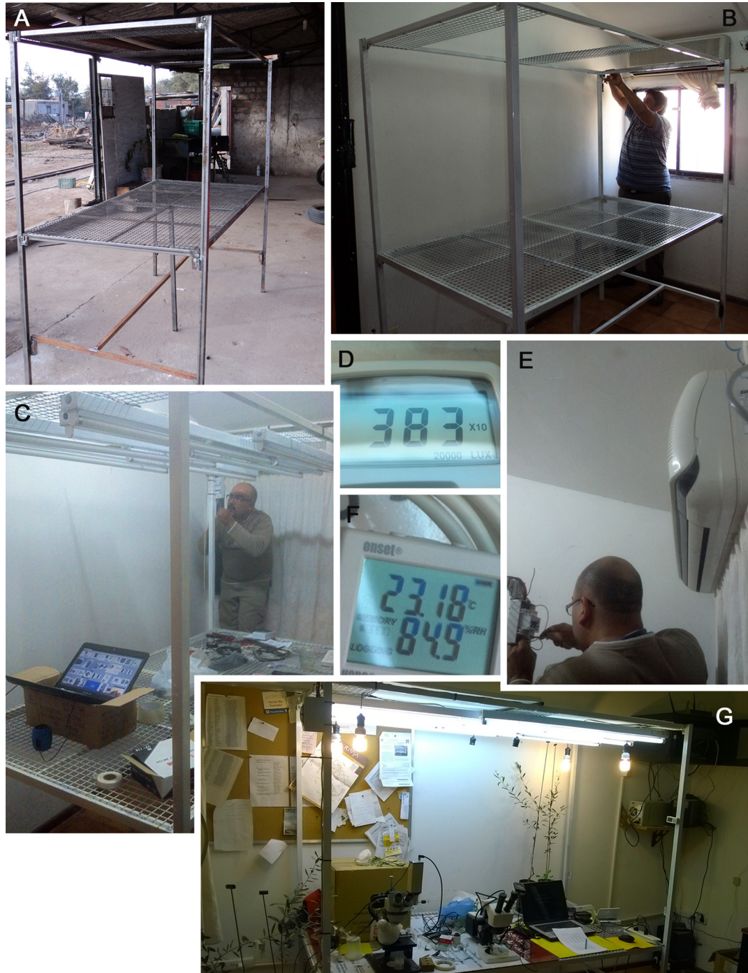
Figura 29. Cámara de cría Laboratorio de la AER Aimogasta. A, B, C, E. Armado e instalación eléctrica de la cámara de cría. D. Luxómetro. F. Data logger. G. Cámara en funcionamiento. (Imagen A-G: Sergio Leiva).
