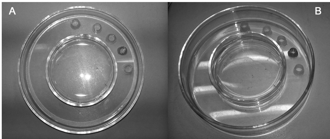
Figura 30. Materiales de Laboratorio. Placa de petri adaptada con cámara húmeda y celdas de incubación. (Imagen A y B: Sergio Leiva).
