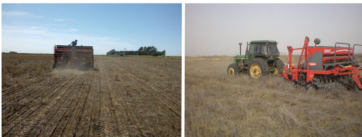
Imagen 16: maquinaria de siembra directa con cajón alfalfero utilizada para la implantación de pasturas perennes en el partido de Villarino.
