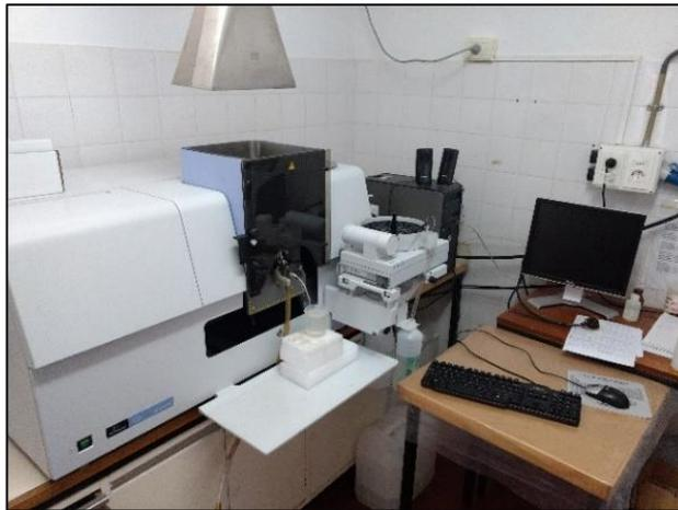
**Figura 2:** Equipo de absorción atómica Perkin Elmer AAnalyst 700.
