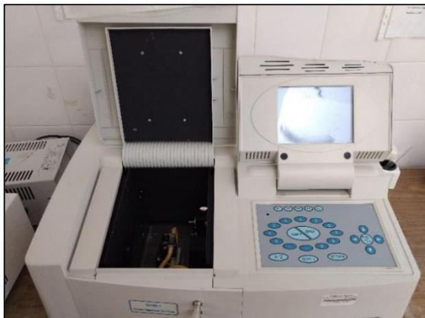
**Figura 3:** espectrofotómetro UV-Vis PG Instruments T-80.
