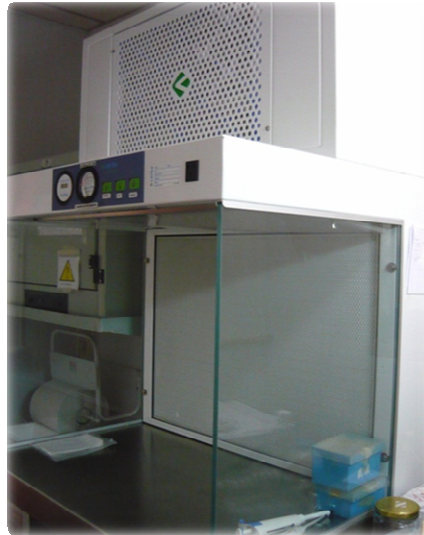
Figura II.15. Flujo laminar Marca Casiba, modelo: modelo HL-1. – Lab. Calidad de leche INTA EEA Rafaela
