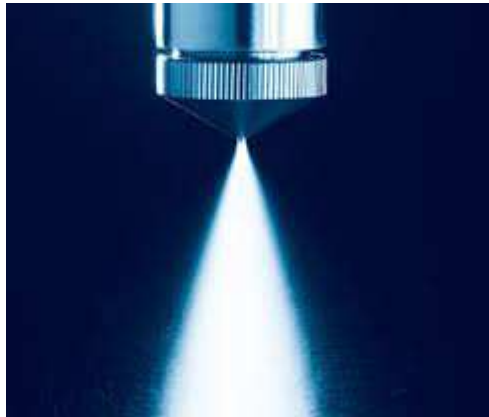
Figura II.5. Tobera de dos fases del Mini Spray Dryer Büchi B290
