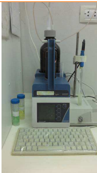
Figura II.18. pHmetro automático . Marca: Schott Instruments, modelo: Titroline Alpha Plus TAOS. Lab. Calidad de leche INTA EEA Rafaela
