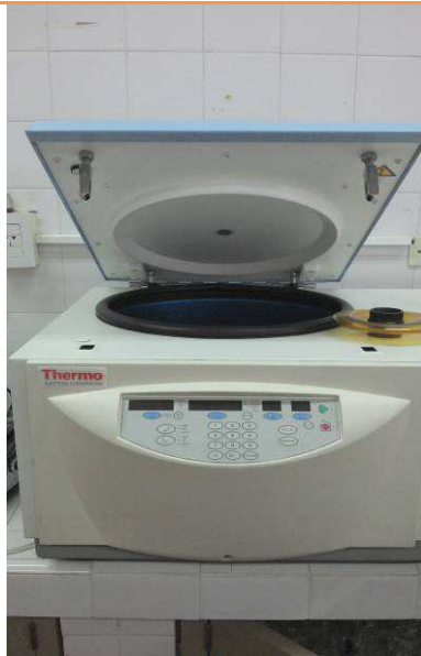
Figura II.17. Centrifuga refrigerada de mesa. Marca: Thermo, modelo: Multi RF. Lab. Calidad de leche INTA EEA Rafaela
