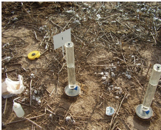
Figura 3. Infiltración y Da en surco y entresurco sobre rastrojo de rastrojo de algodón en SE (ensayo Rotaciones en SD-2010).
