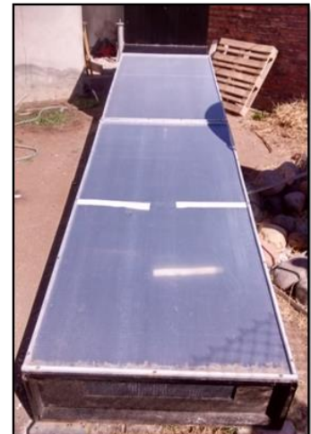
Figura 12: Cobertura total del colector solar con polietileno LTD.
