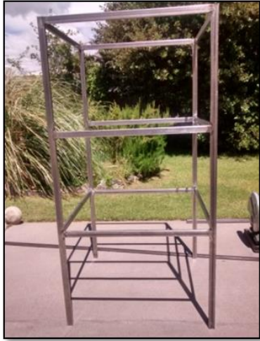
Figura 13: Estructura de la torre de secado.
