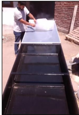
Figura 11: Cobertura del colector solar.
