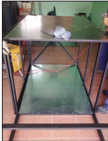
Figura 15: Revestimiento de torre de secado con chapa negra.
