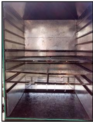
Figura 19: Bandejas y guías en la torre de secado.
