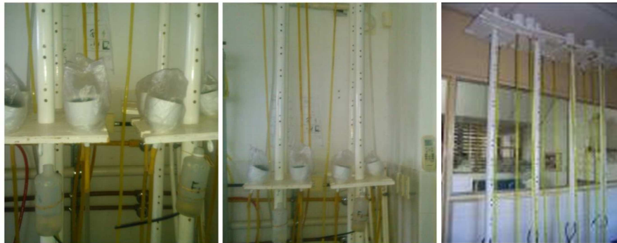
Figura 25: Mesa de tensión con placas de yeso para la determinación de la distribución de tamaño de poros.
