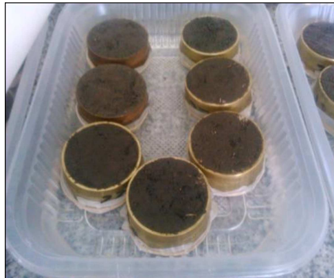
Figura 26: Cilindros de muestra no disturbada en proceso de humectación.
