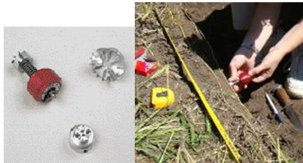
Figura 24: Instrumental utilizado y forma de medición de RC a campo. Extraído de Sasal (2012).
