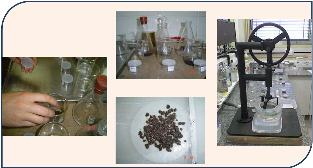
Figura 27: Imágenes de los pre tratamientos de laboratorio de la metodología de Le Bissonnais (1996), extraído de Gabioud (2009).
