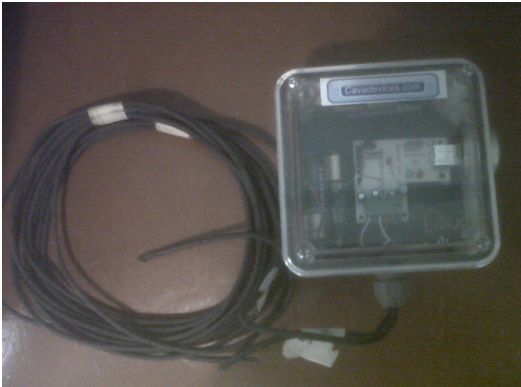
Anexo 8.16. Data logger Cavadevices® para registro de temperatura del suelo.
