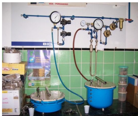
Figura 4. Membrana de Richard para determinar el Punto de Marchitez Permanente (PMP).
