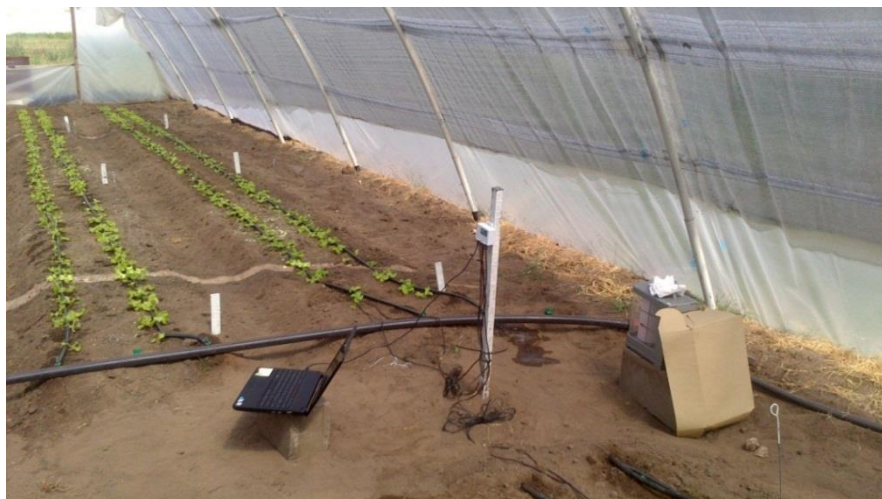
Fotografía 5: Sondas para medir humedad edáfica marca Decagon, modelo EC-5 junto con un Data Logger
