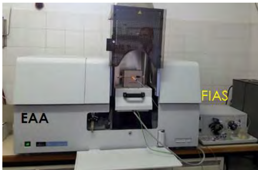
Figura 12. Plataforma de hidruros FIAS 100 (derecha) acoplada al espectrofotómetro de absorción atómica AAnalyst 700 (izquierda).
