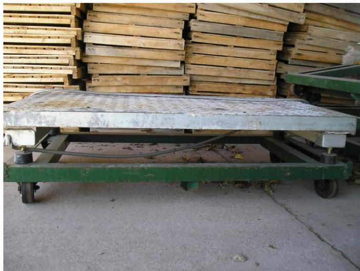
**Figura 3.5 Detalle de balanza Balcopan de peso continuo sobre carro, Planta Piloto de Deshidratado de Frutas EEA Rama Caída.**
