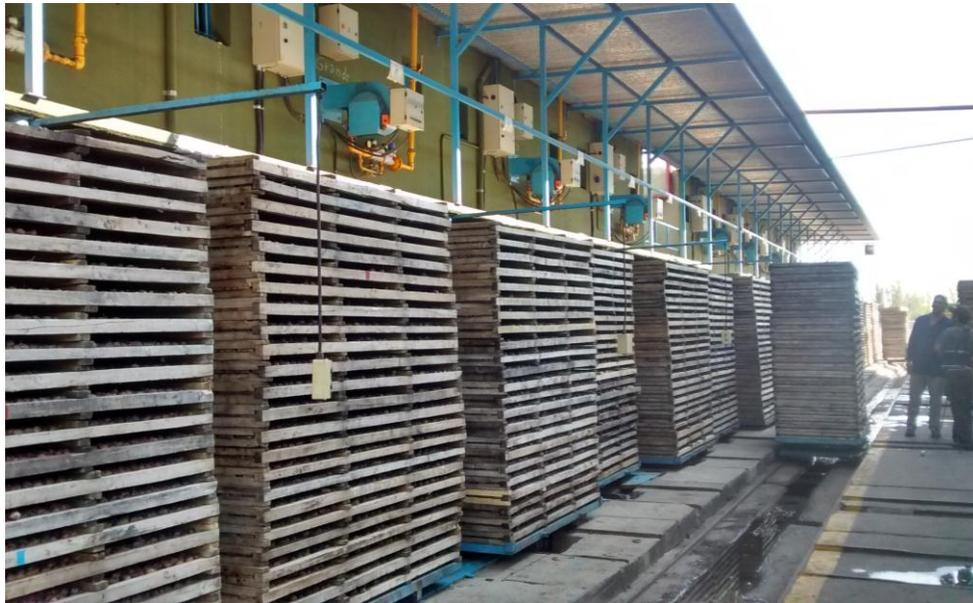
**Figura 1.16 Ingreso de carros con ciruela fresca en hornos, funcionamiento a contracorriente, PROA S.A.**
