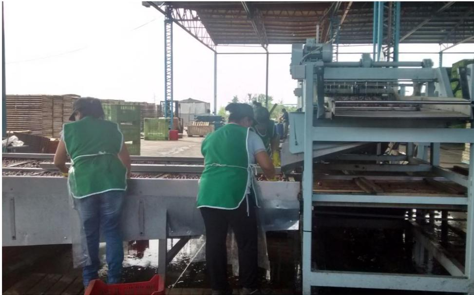
**Figura 1.11 Tamañadora de ciruelas frescas en planta industrial de PROA S.A.**
