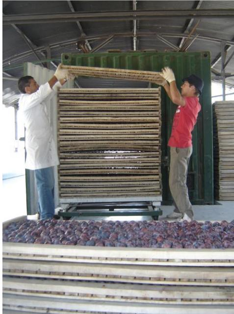
**Figura 3.2 Carga de bandejas con ciruela sobre carro con balanza, Planta Piloto de Deshidratado de Frutas EEA Rama Caída.**
