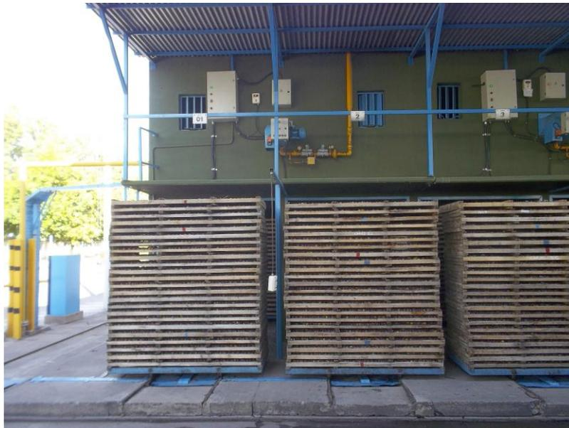
**Figura 3.11 Hornos industriales, zona de menor temperatura y mayor humedad, PROA S.A.**
