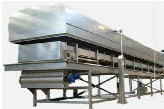
**Figura 1.21** Equipo de tiernizado a vapor, ALBION S.A. Gentileza O. Dal Pozo.
