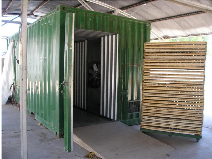
**Figura 3.4 Detalle del ventilador lateral en horno, Planta Piloto de Deshidratado de Frutas EEA Rama Caída.**
