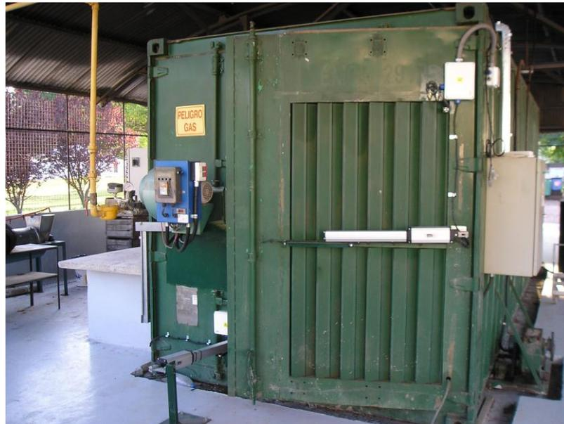
**Figura 3.1 Horno con un túnel, Planta Piloto de Deshidratado de Frutas EEA Rama Caída.**
