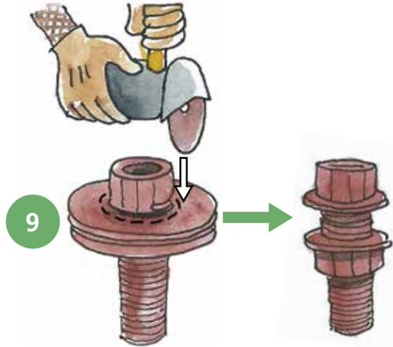
Para la **pieza 10** del pistón, sugerimos utilizar una ojota en desuso. Esta pieza la cortamos de igual diámetro que el tubo, 50 milímetros, y la colocamos entre las roscas de la brida, ajustándola entre ambas bridas de modo que entre a presión en el tubo.
