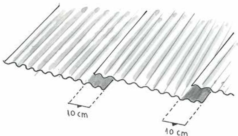
Sobre la estructura se montan las chapas con un 10% de solapamiento, siempre hacia el mismo lado, utilizando tornillos autoperforantes con arandela de neoprene cada 15-30 centímetros, según estructura.
