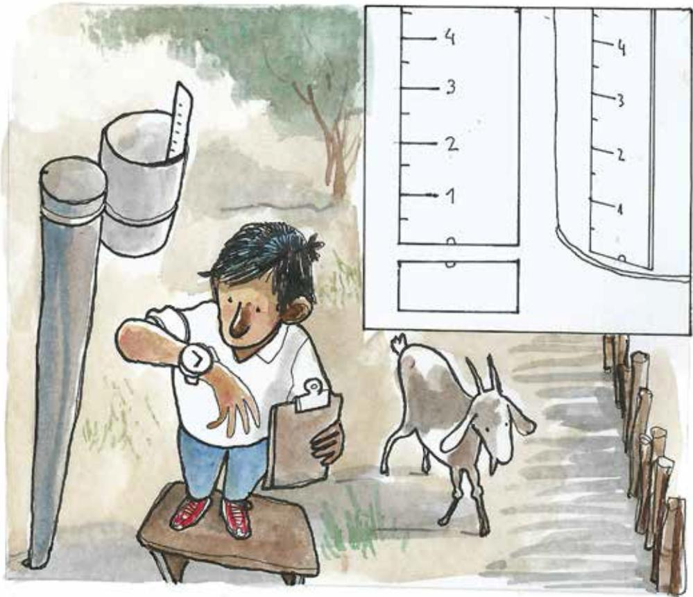
Podemos hacer un pluviómetro casero utilizando una lata de conservas (las que son cilíndricas), y medimos utilizando una regla escolar a la cual cortamos hasta la línea del 0 (cero).
