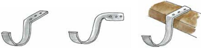
Los soportes de canaleta vienen con el soporte perpendicular, por lo que hay que "enderezarlo", de manera que quede paralelo al suelo, doblándolo con una pinza manual. Las canaletas se solapan colocando primero la canaleta más alta y apoyando el extremo, sobre la siguiente, para evitar que el agua filtre (reforzar la unión de los tramos de canaleta con remaches).
