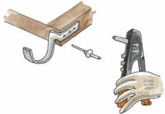
Tendrá una pendiente de 5% hacia la descarga, lo que equivale a 3 centímetros en los 6 metros de recorrido. Para las canaletas hay muchísimas opciones, incluso cortando un caño; pero las circulares, trapezoidales o rectangulares de zinc tienen mayor duración (hasta se pueden hacer plegando una chapa).
