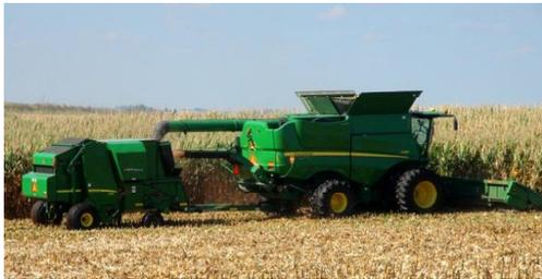
**Figura 4.** Sistema de enrollado de residuos en una sola pasada.
