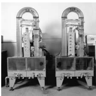
Figura 24. Se utilizan máquinas clasificadoras de corriente de aire para determinar madurez y grados de pasas "Substandard" o "B o mejor". Se ordenan utilizando un flujo de aire continuo a una temperatura y presión constante. Foto: Jack KellyClark.
