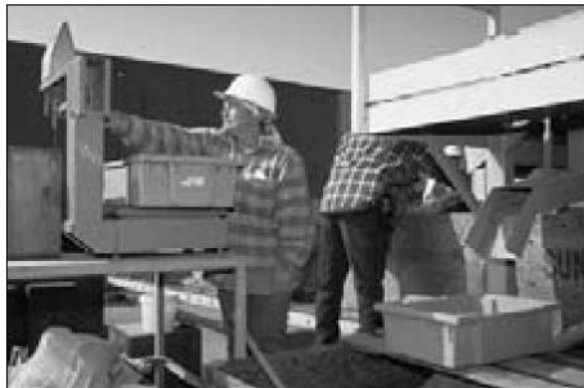
Figura 20. La arena que cae a través del agitador se recoge cuando los contenedores se descargan. La arena se pesa y el promedio por contenedor es deducido del peso bruto entregado. Foto: Jack Kelly Clark.
