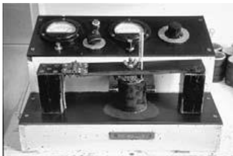
Figura 23. Determinación exacta del porcentaje de humedad requiere que se haga corrección para compensar la temperatura. El termómetro debe colocarse cuidadosamente en la pasta de pasas.
