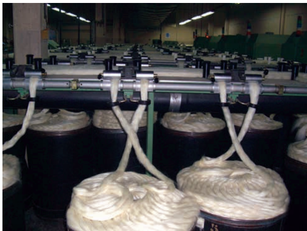
Figura 7. Bobinas de mohair lavado y peinado en la planta industrial de Pelama Chubut S.A. ubicada en Trelew, Chubut (foto año 2007).
