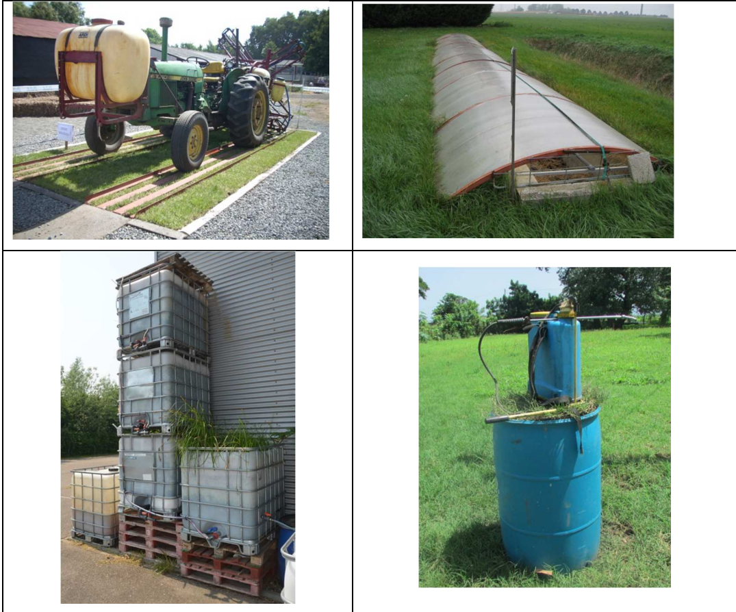
Figura 8. Biobeds en el mundo: a) biobed experimental en la Universidad de Temuco, Chile. b) Phytobac, el modelo comercial de Bayer CropScience c) biofiltro con cuatro módulos en Holanda y d) biodep tipo mesa para mochilas en Guatemala.
