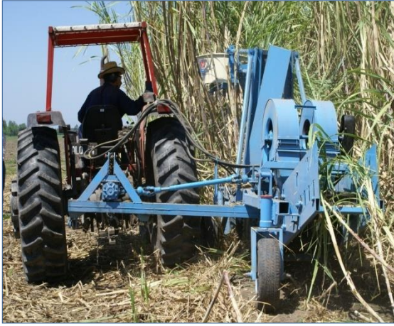
Figura 2.1: Máquina utilizada en la cosecha reducida. Peso aproximado 2.500 kg.
