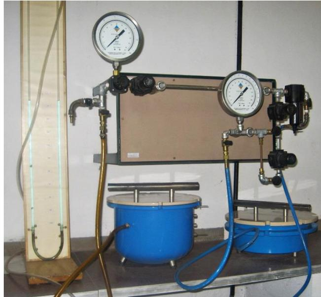
**Figura 2.1:** Equipo extractor de presión membrana (Soil-Moisture) utilizado en la obtención de los datos necesarios para confeccionar las curvas de retención hídrica.
