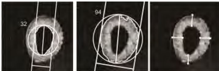
Figura 3. Parámetros geométricos de la sección transversal del tallo, determinados en las fotografías. (izq) ÁREA.INT , D.FERET.INT.MÍN y D.FERET.INT.MAX . (centro) PERÍMETRO , ÁREA.EXT y D.FERET.EXT.MÍN y D.FERET.EXT.MAX .(derecha) EPEB .
