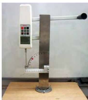
Figura 4. Dinamómetro utilizado para registrar la fuerza de quiebre.
