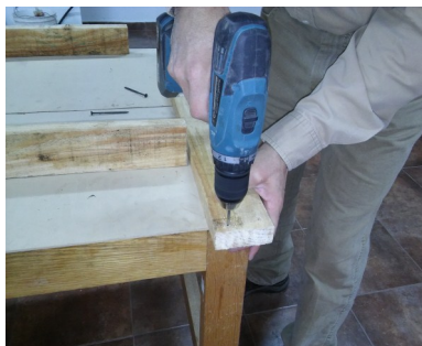
Foto 6: Perforado de la tabla
