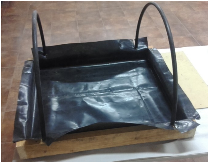
Foto 12: Varillas de hierro revestidas.
