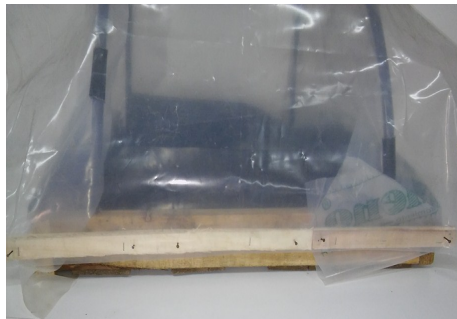
Foto 20: Listón clavado en la parte posterior de la plantinera, sujetador de tapa.
