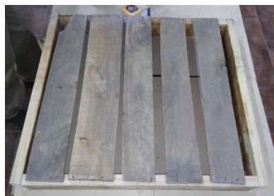
Foto 9: Armado de la base de la caja con tablas finas fijadas a
