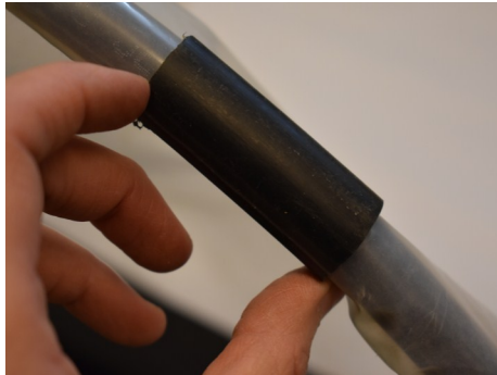
Foto 19: Polietileno en laterales, sujetos con recorte de manguera
