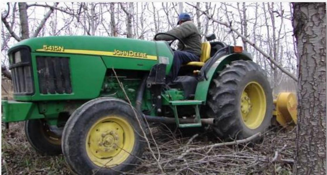
Conjunto tractor (con bajo grado de obsolescencia) y trituradora de podos
