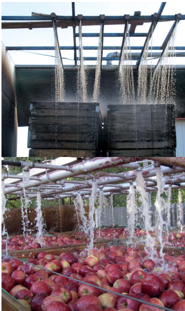
Figura 3. Una ducha que no se distribuye de manera uniforme sobre toda la superficie de los bins (arriba), así como orificios obturados (abajo) resulta en un tratamiento irregular y poco efectivo
