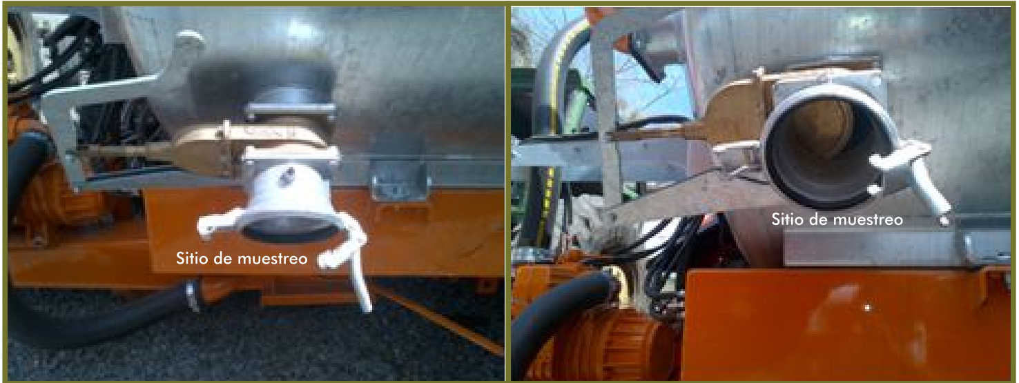
Figura 17. Muestreador automático ubicado en diferentes partes del tanque estercolero.
