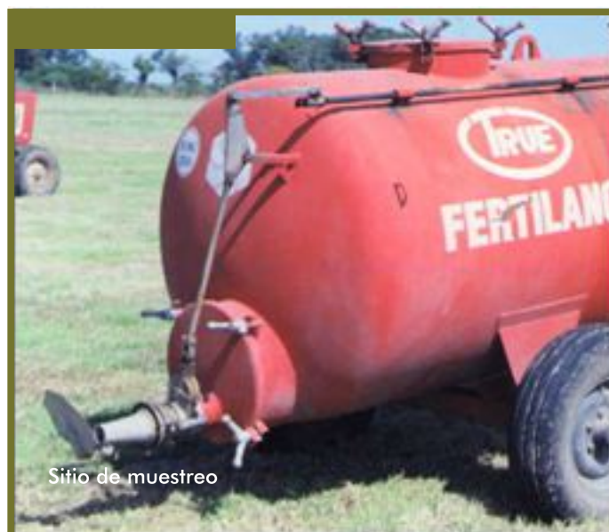
Figura 18. Descarga del tanque cisterna donde se realiza el muestreo.
