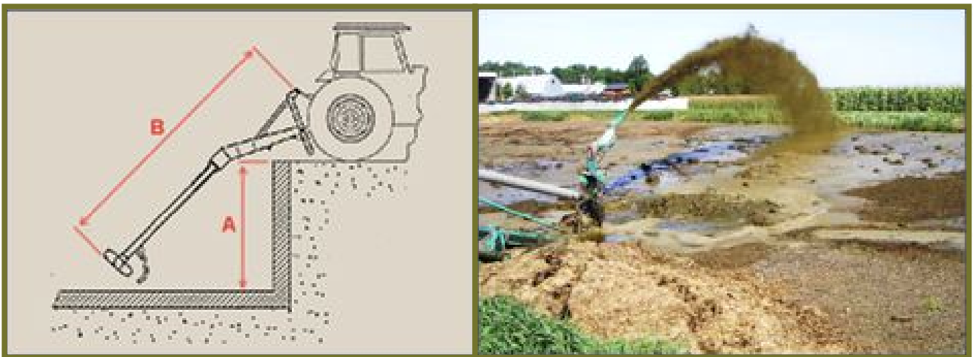
Figura 14. Esquema de un agitador mecánico (izquierda) y una bomba de agitación en funcionamiento (derecha).
