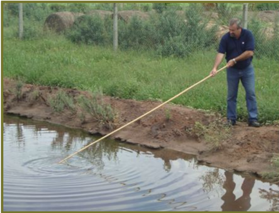
Figura 12. Procedimiento de muestreo de una laguna de almacenamiento o tratamiento previo al vaciado.
