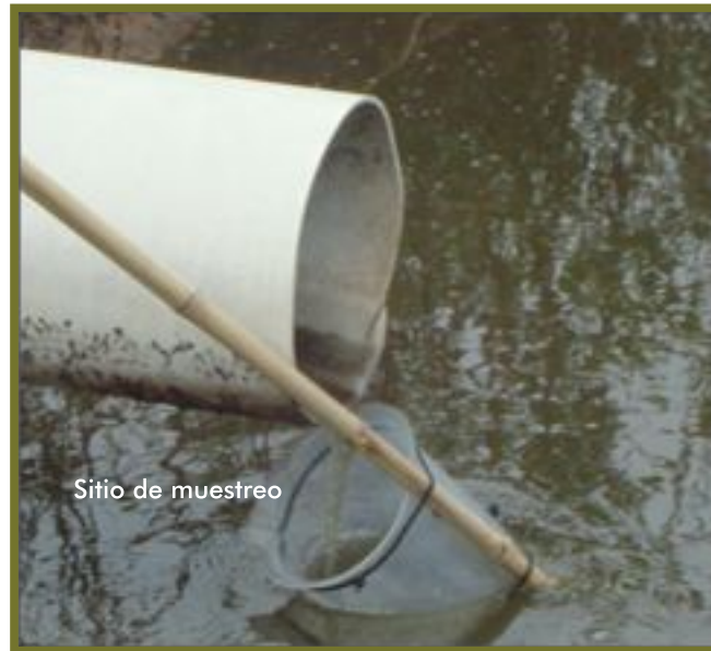
Figura 20. Procedimiento de muestreo de una laguna de almacenamiento o tratamiento previo al vaciado.
