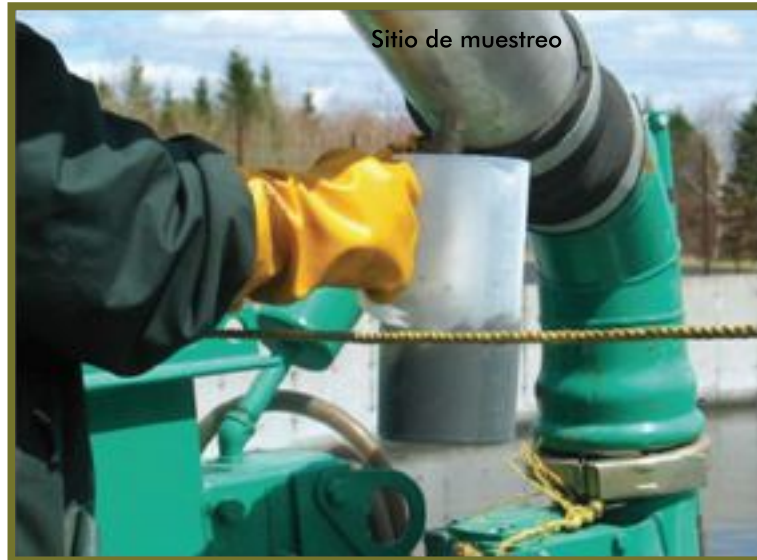
Figura 15. Bomba agitadora y de carga del efluente dispone de un muestreador automático.
