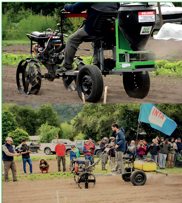
Figura 5: Aplicación de abonos. Arriba: aplicación de fertilizante peletizado orgánico (biorganutza). Abajo: Prueba de aplicación de fertilizante líquido orgánico.
