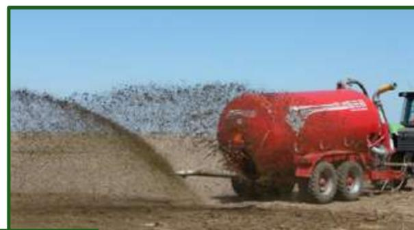
Figura 18-7 Estercolera para aplicación de efluentes líquidos.
