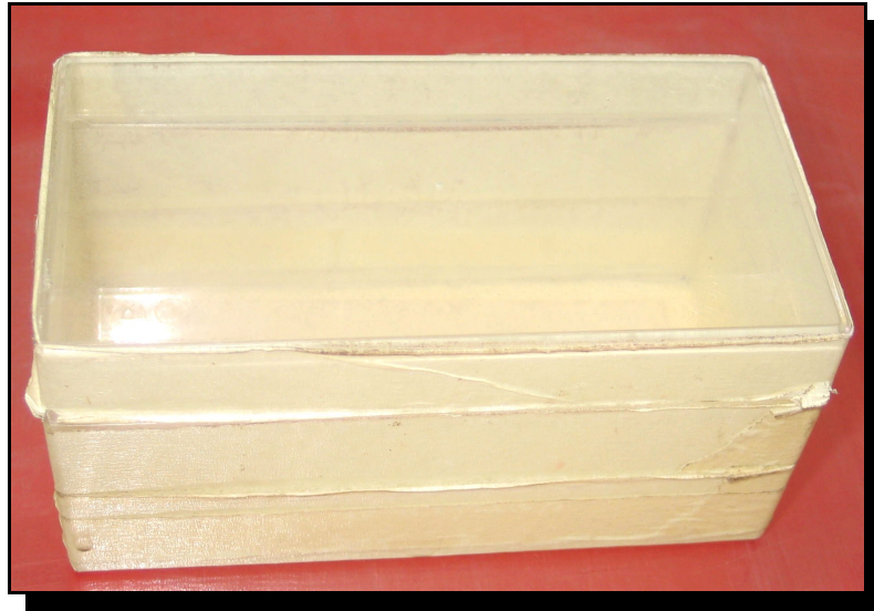
Foto I.4. Caja de acrílico para medir atracción dentro de un gradiente químico (foto de la autora, 25X).
