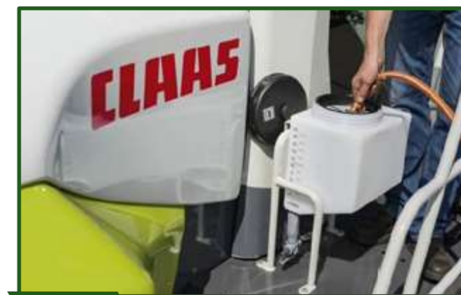
Figura 15-6 Vista del tanque del sistema Actisiler® de CLAAS, para trabajar con inoculantes de alta concentración y dosis de ultra bajo volumen. Fuente: CLAAS Argentina.
