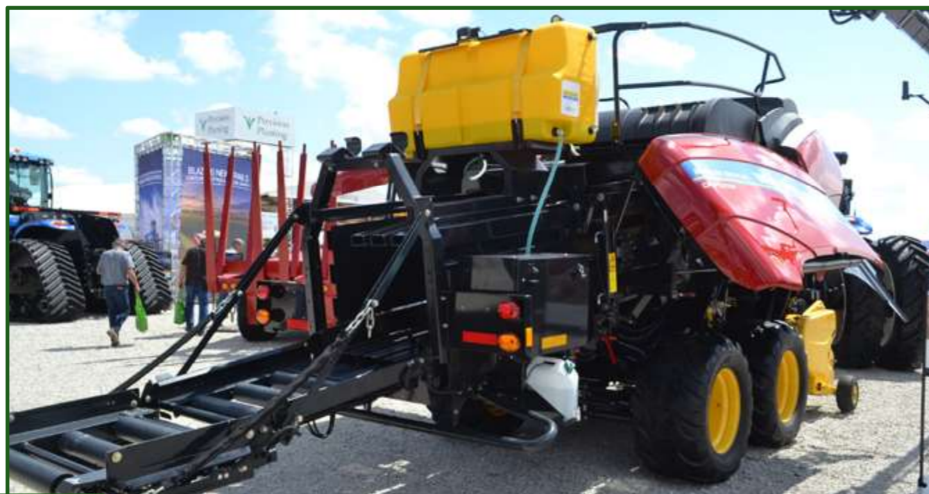
Figura 15-9 Megaenfardadora equipada con sistema "Crop Saver buffered acid®" para la aplicación de ácido orgánico mezclado con ácido cítrico, lo cual permite realizar la henificación con un mayor contenido de humedad.
