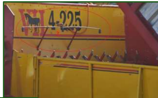
Figura 15-8 Detalle del sistema de inoculación en una máquina embolsadora. Se observa el tanque depósito (1) y la línea hidráulica con las pastillas de distribución sobre las bateas (2).
