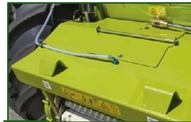
Figura 15-5 Línea de inoculación ubicada en el sector de alimentación de una picadora autopropulsada (Esta ubicación se utiliza para trabajar con dosis de bajos volúmenes). Fuente: CLAAS Argentina.
