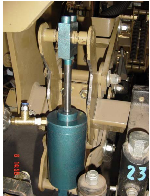
FIGURA 2.5.: Cilindro neumático en expansión ante la elevación del cuerpo de siembra.
