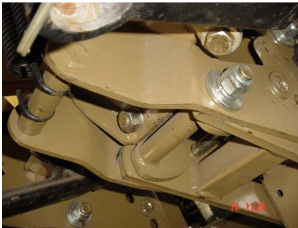
FIGURA 2.1.: Sistema palanca para la transferencia de carga al cuerpo de la sembradora.
