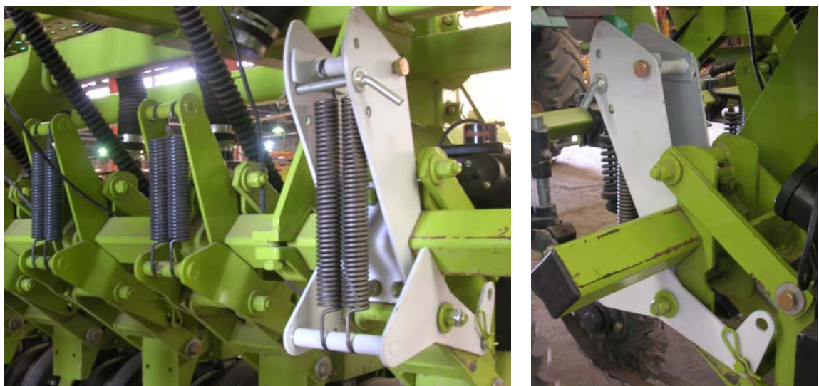
FIGURA 2.7.: Sistema de transferencia de carga diseñado en el Laboratorio de Terramecánica e Implantación de Cultivos del Instituto de Ingeniería Rural (INTA Castelar). El montaje sobre una máquina comercial permite apreciar las diferencias respecto del diseño estándar.
