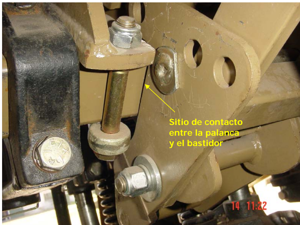
FIGURA 3.2: Límite superior de elevación del cuerpo de siembra: contacto entre la palanca de transferencia de y el bastidor. En esta figura el perno de regulación se encuentra en la posición 3.
