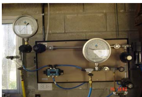
FIGURA 2.6.: Manifold utilizado para entregar presiones de 0 a 5 bar al cilindro neumático.
