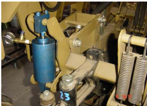
FIGURA 2.4.: Reemplazo de los resortes por el cilindro neumático.
