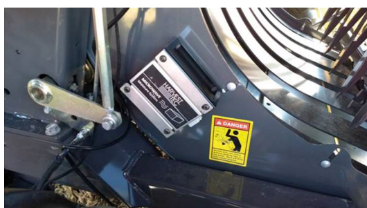
■ Figura 13. Sensor de humedad incorporado en la garganta de ingreso de material en una megaenfadadora.
