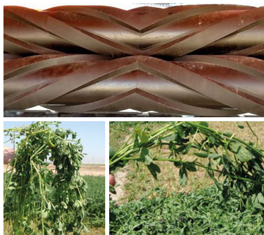
■ Figura 8. Rodillos acondicionadores (arriba) que quiebran los tallos generando nuevos puntos de escape del agua (abajo, izquierda y derecha), acelerando el secado y permitiendo conservar mejor la calidad de la fibra para enrollar o enfardar.
