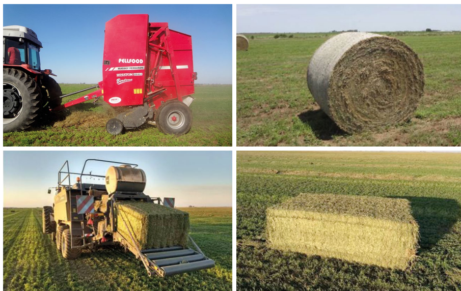
■ Figura 17. Rotoenfardadora (mitad superior) y megaenfardadora (mitad inferior) de la firma AGCO utilizadas en distintos ensayos realizados en conjunto con el INTA Manfredi.
