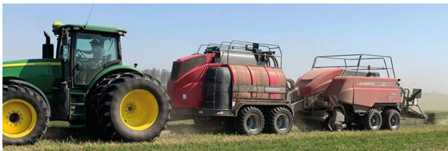
■ Figura 14. Vaporizadora DewPoint®, de la firma Staheli West (EE. UU.), en plena operación de megaenfardado de andanas excesivamente secas. Foto: gentileza AGCO Argentina.
