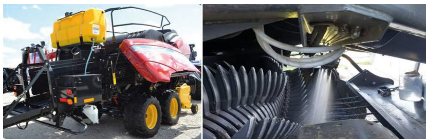
■ Figura 16. Equipo aplicador de conservantes colocado en megaenfardadoras New Holland y AGCO, capaz de realizar la pulverización de los productos directamente sobre el heno al momento de su recolección. Fotos: Farm Progress Show 2017.
