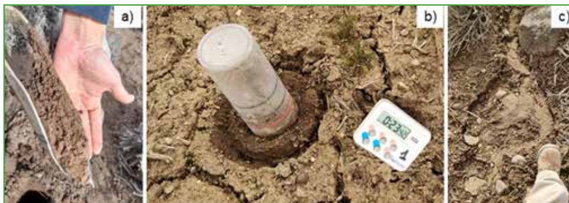
Figura 2: a) Suelo húmedo en primavera. b) Medición del índice de infiltración. c) Surco de escurrimiento superficial de agua.
