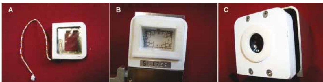
Figura 6: Distintos sistemas de iluminación utilizados por el sistema LI-6400. A) Sun+Sky; B) 6400-02; C) 6400-40.
