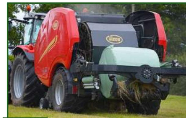
**Figura 12-26** Rotoenfardadora – empaquetadora Vicon FastBale, con precámara de compactación para aumentar la capacidad de trabajo al evitar detenimientos, durante el atado y la cobertura con film.
