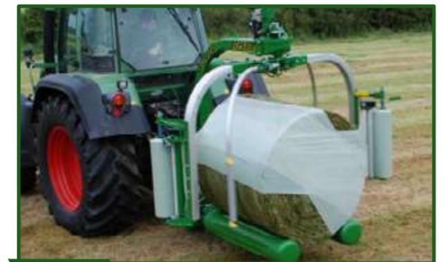
Figura 12-23 Recolección del rollo mediante los mismos rodillos de soporte de la mesa de empaquetado. Los rodillos se cierran y comienzan a girar sobre sí mismos hasta lograr levantar el rollo.
