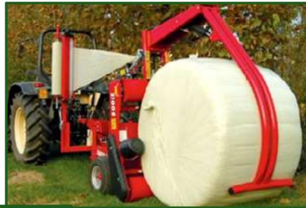
**Figura 12-24** Brazo de mando hidráulico para recolección y descenso suave del rollo, al mismo tiempo que la mesa de empaquetado se inclina tocando el suelo.
