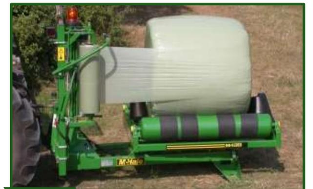
**Figura 12-7** En el empaquetado del rollo es importante considerar que el viento debería estar en la misma dirección en que se observa la fotografía, para permitir el correcto pegado de las sucesivas capas de film.
