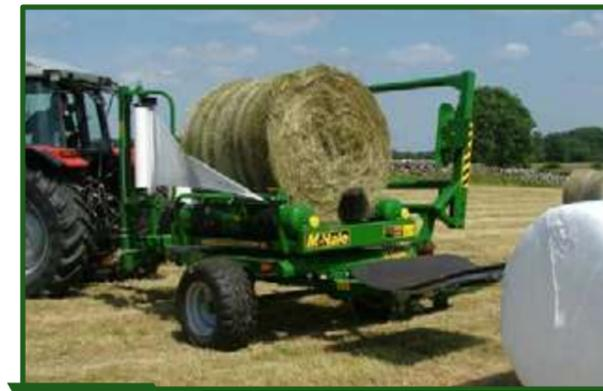
**Figura 12-9** Mesa de empaquetado de rollos, previamente confeccionados por una rotoenfardadora, para confección de henolaje como silopaq.
