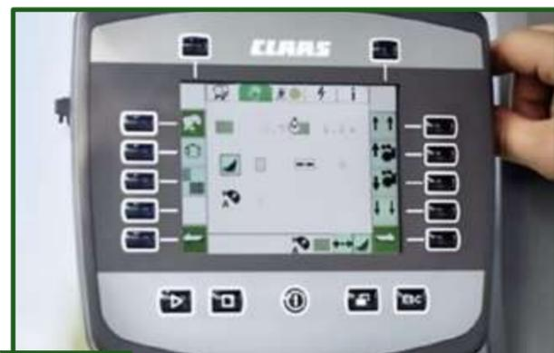
Figura 12-18 Monitor de comando de la mesa de empaquetado, que permite variar las condiciones de trabajo desde la cabina del tractor.
