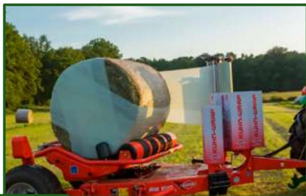
**Figura 12-11** En la fotografía se puede observar la superposición al 50 % de las capas del film lograda a partir de una correcta regulación de los rodillos que soportan el rollo y de la velocidad de giro del brazo conductor del film.
