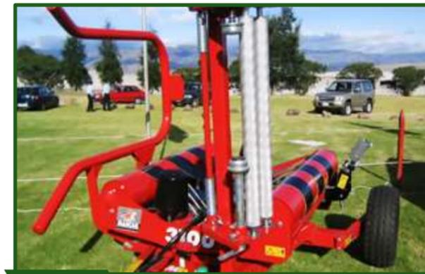
Figura 12-20 Porta bobina, para film de 1 m de ancho.
