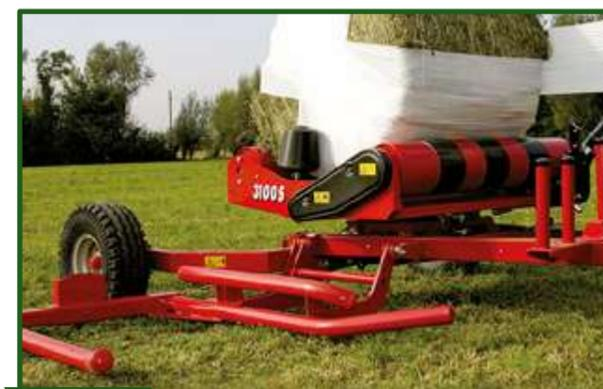
Figura 12-21 Sobre el suelo puede verse la unidad responsable de recoger el rollo y depositarlo en la mesa propiamente dicha.
