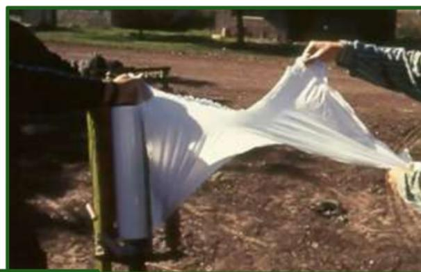
Figura 12-37 Prueba de desgarramiento para verificar la calidad del film.
