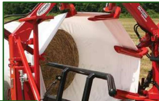
Figura 12-30 Detalle de las uñas que sujetan la bolsa para su estiramiento.
