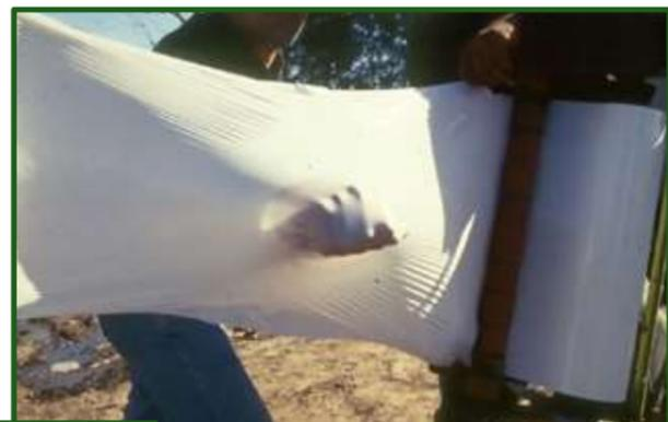
Figura 12-36 Prueba del puño para evaluar la calidad del film.
