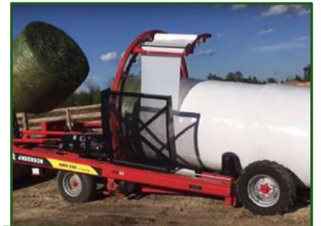
**Figura 12-28** Mesa de empaquetado de líneas de rollo.
