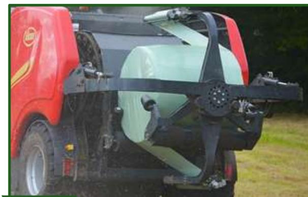
**Figura 12-16** Sistemas de embalaje con dos brazos porta bobinas.
