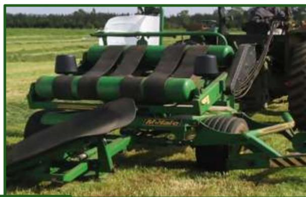
**Figura 12-12** Mesa empaquetadora con cuatro correas, para la correcta tracción del rollo.
