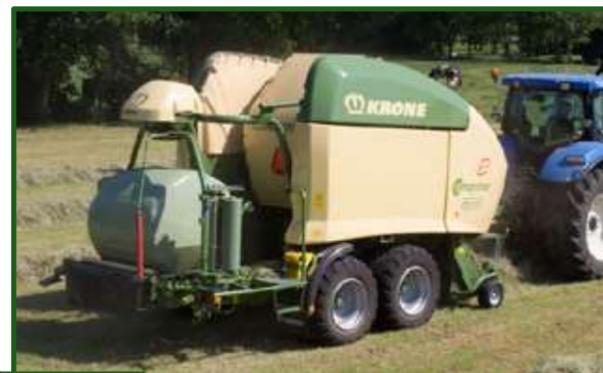
**Figura 12-8** Rotoenfardadoras-empaquetadoras para confección de henolaje en formato de rollos individuales conocido como silopaq. Confecciona y envuelve el rollo de pastura en una sola operación.
