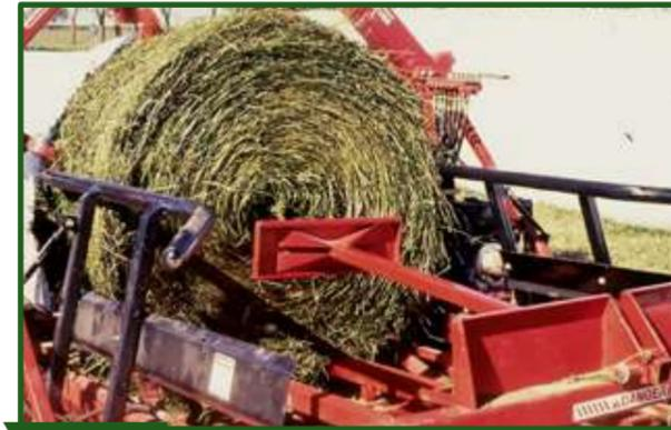
Figura 12-33 Pistón extensión para introducir el último rollo en la bolsa.
