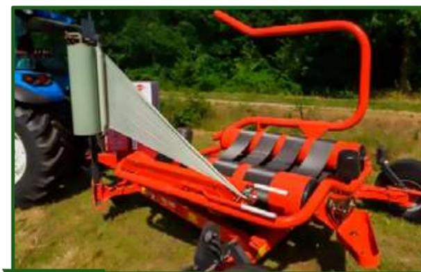
**Figura 12-15** Sistema de atado en encintadora, cuya mesa empaquetadora genera el movimiento rotacional en ambos sentidos (longitudinal y vertical).
