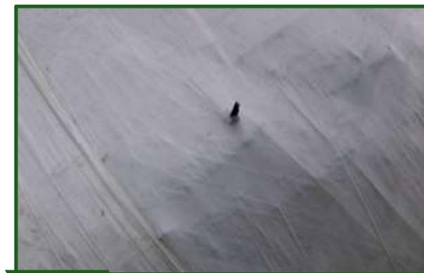
Figura 12-4 Se observa el perforado de la cobertura plástica, debido a un tallo en un henolaje bajo formato de rollo.
