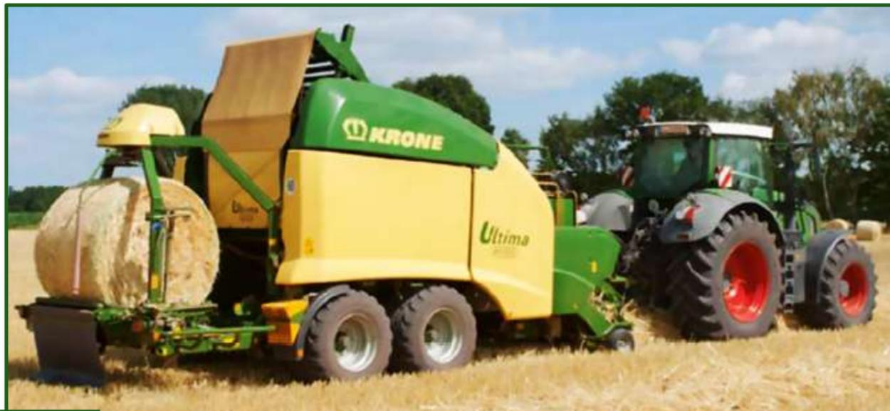
**Figura 12-25** Rotoenfardadora – empaquetadora Ultima CF 155 xc de la firma Krone con precámara de compactación, que permite la confección y empaquetado sin detenimientos.
