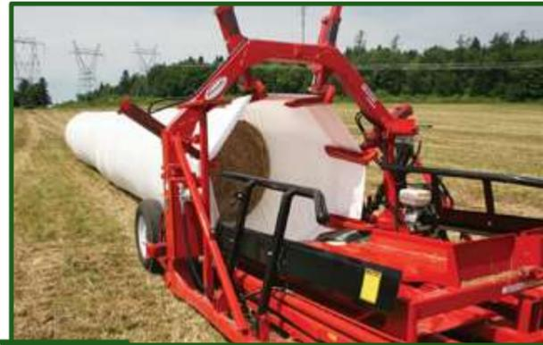
Figura 12-29 Vista de la embolsadora con motor incorporado
