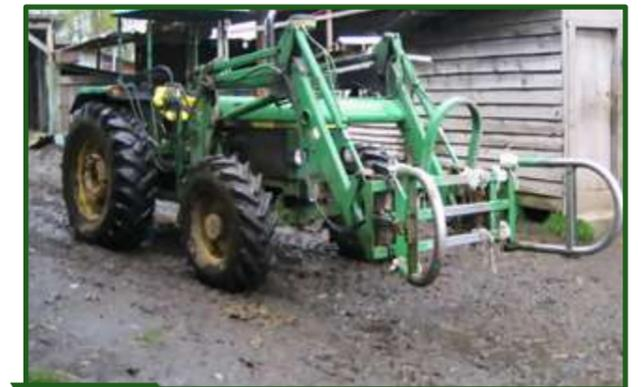
Figura 12-35 Dispositivo para mover rollos empaquetados, sin riesgo de rotura del plástico.
