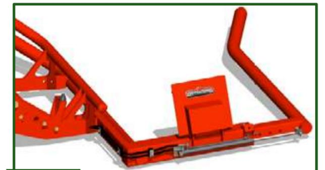
Figura 12-22 Se puede observar la regulación o espaldera del rollo para centrarlo en la mesa.
