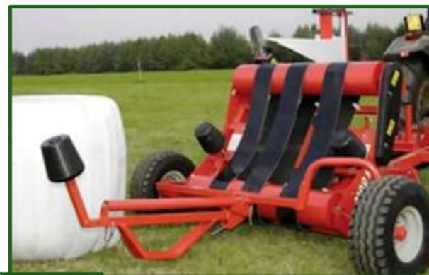
**Figura 12-14** Rampa e descarga de doble acción, que permite depositar el rollo parado sobre su cara plana.
