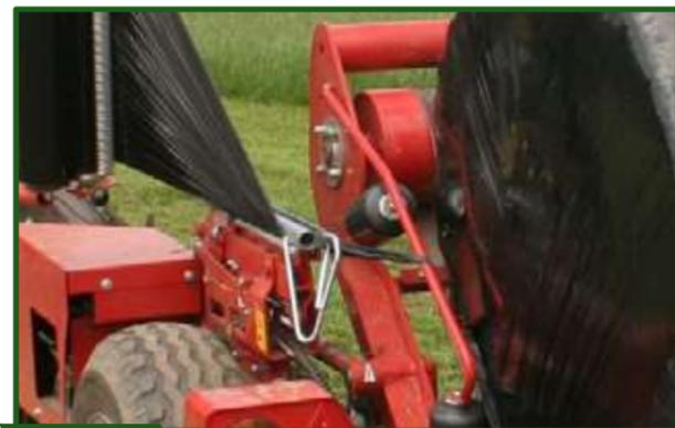
Figura 12-17 Detalle del cortador automático del film.
