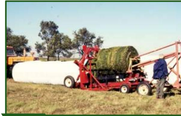
Figura 12-32 Una vez comenzado el trabajo no hace falta contar con tope posterior.
