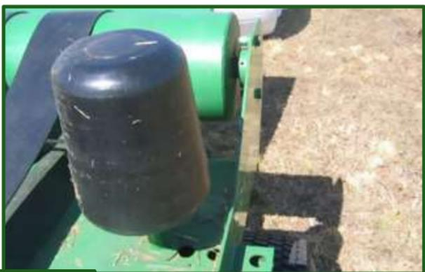
**Figura 12-13** Se puede observar contra el rollo, el tope que permite que gire sin desequilibrarse sobre la mesa.
