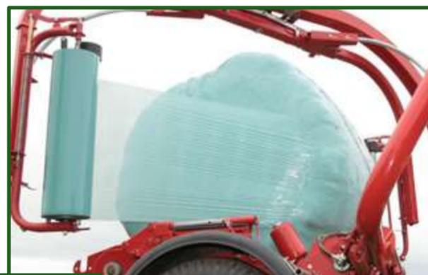
Figura 12-19 Al momento de la salida del film se observa que el mismo se achica un 15 % en su ancho.
