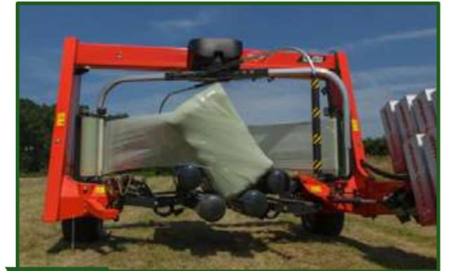
**Figura 12-27** Empaquetadoras de megafardos. Permiten obtener enolaje bajo este formato de forraje.
