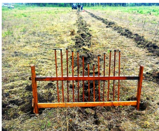
Figura 2.3: Perfilómetro utilizado para determinar la sección de suelo alterada
