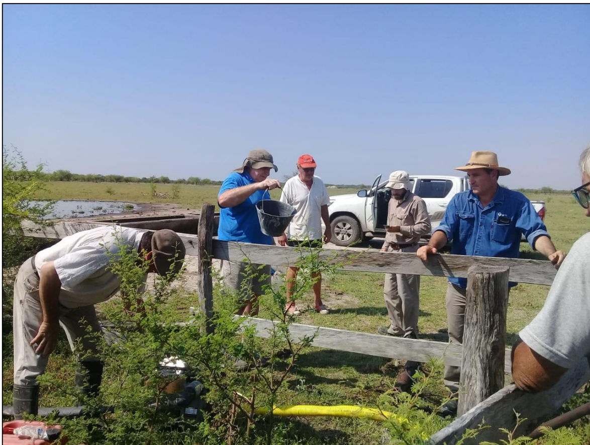
Preparando para hacer una prueba de aforo de la bomba y medición del nivel dinámico en la perforación.
