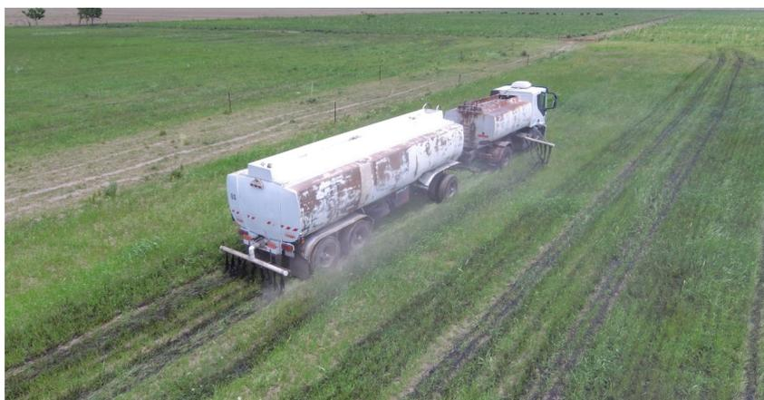
Figura 8: Sistema actual de aplicación de digerido en caída por gravedad.
