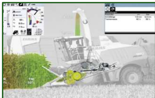
Figura 13-13 Sistema de regulación automática de longitud en función de MS. Permite ajustar el largo de corte automáticamente dependiendo del nivel de MS que le indica el sensor de humedad. En las máquinas Claas Jaguar la variación máxima del largo de corte de referencia +/- 3 mm en maíz.
