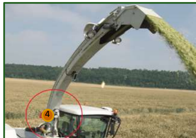
Figura 13-44 pastilla de pulverización de inoculante para diferentes rangos de inoculación (rojo bajo volumen y blanco alto volumen) y diferentes lugares de trabajos. Línea de inoculante que lleva la mezcla al sector del rotor acelerador (2). Línea de inoculantes que lleva la mezcla al sector de alimentación (3). Línea de inoculación de ultra bajo volumen ubicada en el tubo de descarga (4).
