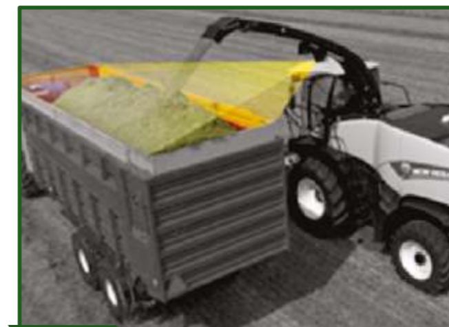
Figura 13-38 Sensor NIR HarvestLb que va ubicado en el codo de descarga de la jirafa de las picadoras John Deere 8000 y que mide en tiempo real MS, FDN, FDA, Proteína y Almidón. Este sensor se puede remover de la picadora y utilizarlo como una unidad fija en una oficina para medir no solo materiales recién picado, sino también silajes ya estabilizados.
