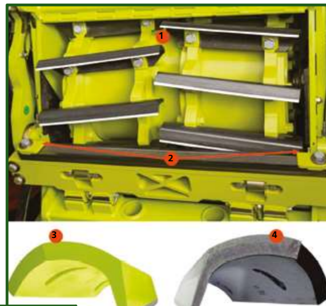
Figura 13-20 Detalle de las cuchillas colocadas en V (1) y detalle de Cuchillas colocadas en V en combinación con una fase de entrada en la contracuchilla (2) que es el lugar donde se produce el corte. Cuchillas en forma de pala (3+4) que permite un eficiente transporte del material una vez que fue cortado contracuchilla. Cuchillas universales (3) y cuchillas específicas de maíz (4).
