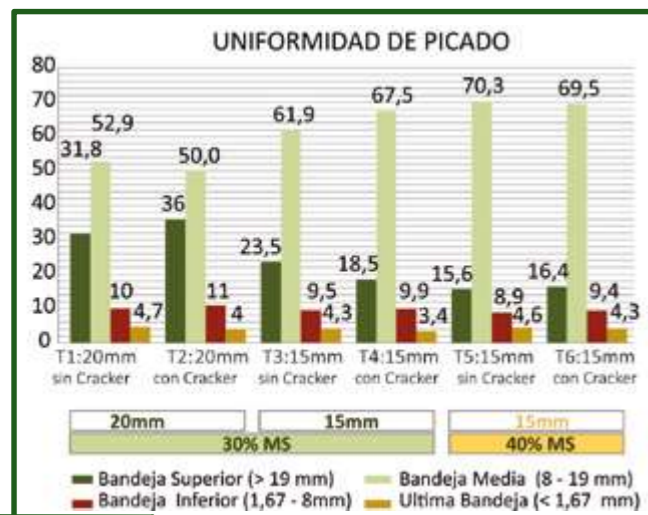
Figura 13-49 Porcentajes retenidos en las cuatro bandejas de Penn State's en los distintos tratamientos.
