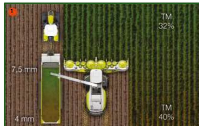
Figura 13-13 Sistema de regulación automática de longitud en función de MS. Permite ajustar el largo de corte automáticamente dependiendo del nivel de MS que le indica el sensor de humedad. En las máquinas Claas Jaguar la variación máxima del largo de corte de referencia +/- 3 mm en maíz.
