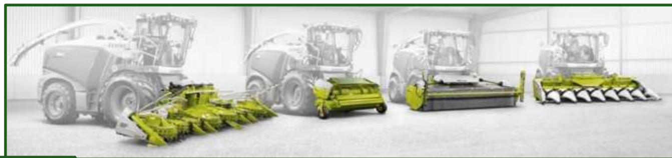
Figura 13-1 Distintas alternativas para equipar a picadoras. Cabezal de cuchillas corta rotantes para picar maíz y sorgo, cabezal pick-up para cultivos que necesitan pre-oreo como alfalfa y cereales de invierno cortado en hoja bandera, cabezal de discos para picar cereales de invierno con grano pastoso y cabezal maicero para realizar earlage.
