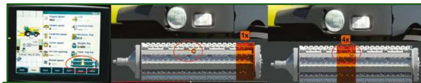
Figura 13-15 Indicador de la sección en la que fue detectado el cuerpo metálico. Modelo FR 600 New Holland.
