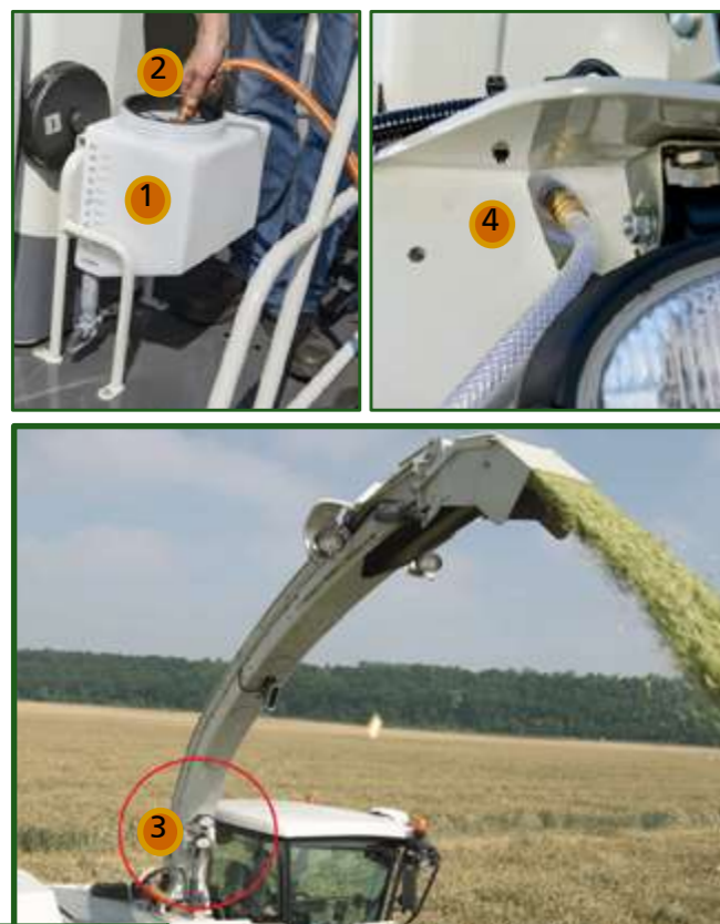
Figura 13-45 Sistema ACTISILER® de CLAAS para aplicación de concentrados biológicos a ultra bajo volumen y alta velocidad. El equipo consta de un tanque de 20 litros de capacidad (1); un indicador de relleno que es visible desde la cabina (2); La tobera de aplicación está ubicada en el codo de la descarga (3); lo que permite la aplicación del concentrado biológico con una alta velocidad de aire (4). Fuente: CLAAS Argentina.
