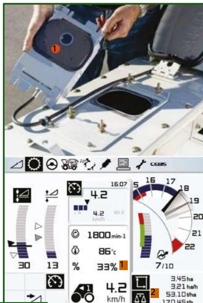
Figura 13-40 Sensor NIR que va ubicado en el codo de descarga de la jirafa (arriba). Indicación continua en CEBIS de los equipos Claas (1), donde se tienen en cuenta continuamente los valores de MS en la determinación del rendimiento (2).
