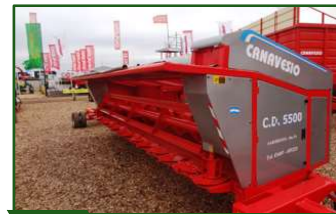
Figura 13-5 Cabezal de corte directo con discos y molinete captador que entregan el forraje a un sinfín y de allí a los rodillos alimentados de la picadora.
