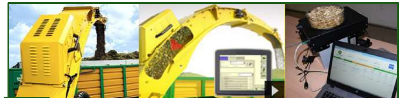
Figura 13-39 Sensor NIR que va ubicado en el codo de descarga de la jirafa (izquierda). Indicación continua en CEBIS de los equipos Claas (1), donde se tienen en cuenta continuamente los valores de MS en la determinación del rendimiento (2).
