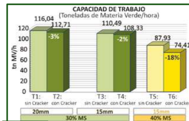
Figura 13-47 Variación de la capacidad de trabajo en función de la MS y el uso de procesador de granos.
