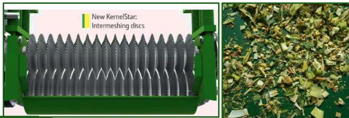
Figura 13-28 Sistema de procesadores KernelStar que equipa la picadora John Deere 8000 y detalle de material picado con alto % MS donde se observa un correcto quebrado de los granos pero donde la fibra no está lacerada.
