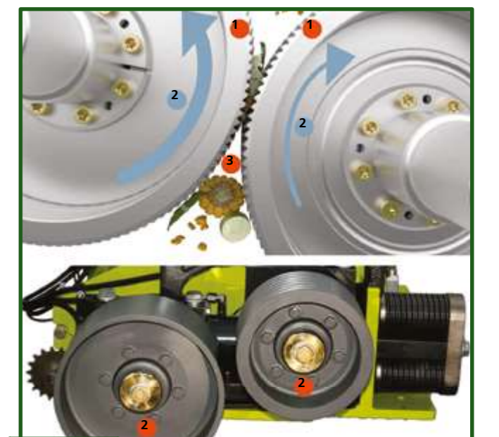
Figura 13-24 Detalle de rodillos quebradores de grano. El principio de funcionamiento de este mecanismo es con un perfil dentado contrapuesto (1) de los dos rodillos, los cuales trabajan a diferentes régimen de revoluciones (2) generando un efecto de fricción entre ellos. Entre ambos rodillos existe una grieta ajustable en milímetros (3).
