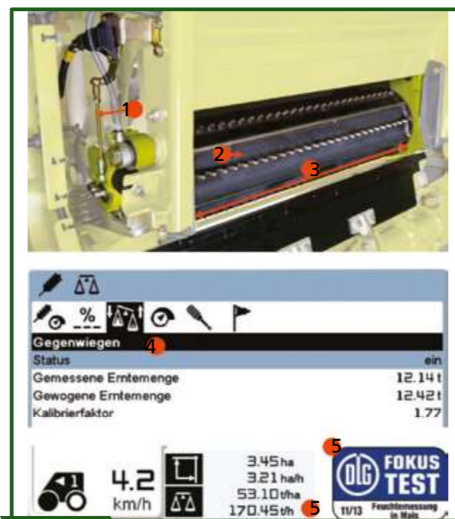
Figura 13-36 Sistema de medición del caudal volumétrico ( m^3 \times peso específico del fruto (g/l) = t/h o t/ha. Es sistema trabaja detectando la inclinación del rodillo de compactación previa superior trasero (1), la velocidad de la alimentación (2) y el ancho de la alimentación (3). Según datos de Claas el sistema necesita un caudal >50 t/h y el calibrado se realiza mediante contrapesado (4).
