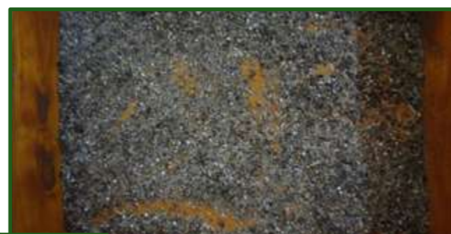
Figura 13-57 Granos dañados por el sistema procesador.
