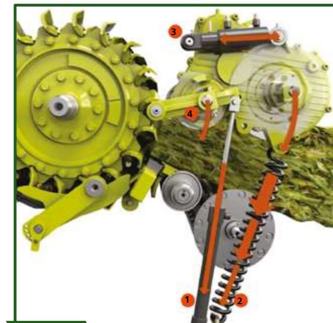
Figura 13-11 El material ingresa a los rodillos y estos producen una compactación previa constante del mismo mediante el trabajo combinado de cilindros de tiro (1), muelles helicoidales (2), un amortiguador hidráulico (3) y rodillos de preensado dirigidos radialmente (4) que permite que la distancia entre estos rodillos y el rotor picador sea siempre constante. Este sistema permite realizar una compactación independientemente de la altura de la capa, o sea del rendimiento que esté teniendo el cultivo. A su vez, genera un reparto homogéneo de la fuerza de compactación previa, con el amortiguador hidráulico.
