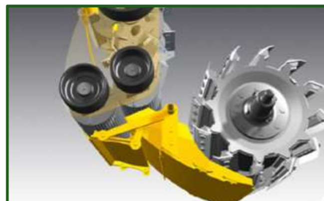
Figura 13-27 Configuración para trabajo sobre pasturas (izquierda) y para picado de maíz/sorgo con procesado de granos (derecha). Fuente New Holland.
