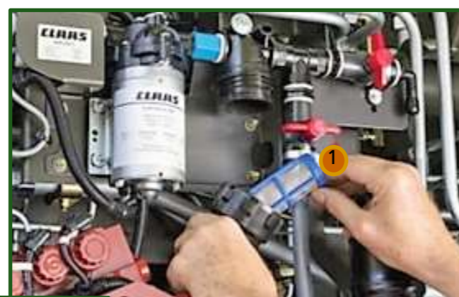
Figura 13-42 Detalle de la bomba del sistema de inoculación, con vista del filtro (1). Fuente: CLAAS Argentina.
