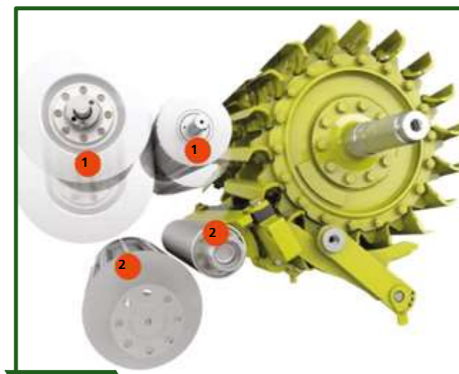
Figura 13-10 Detalle de los 4 rodillos de alimentación del rotor picador. Los dos superiores son los encargados de subir o bajar según la cantidad de material que esté ingresando a la máquina, mientras que los dos inferiores son fijos.
