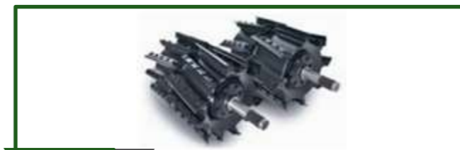
Figura 13-17 Detalle de rotor picador con distinto número de cuchillas. Las cuchillas colocadas en forma de V permiten un corte que ahorra fuerza y permite realizar una entrega centrada del material picado. Las cuchillas luego del corte son las encargadas de realizar el transporte.
