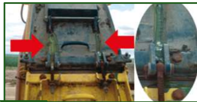
Figura 13-51 Chorreado de jugo sobre la jirafa de la picadora al trabajar con un material con 30 % MS.
