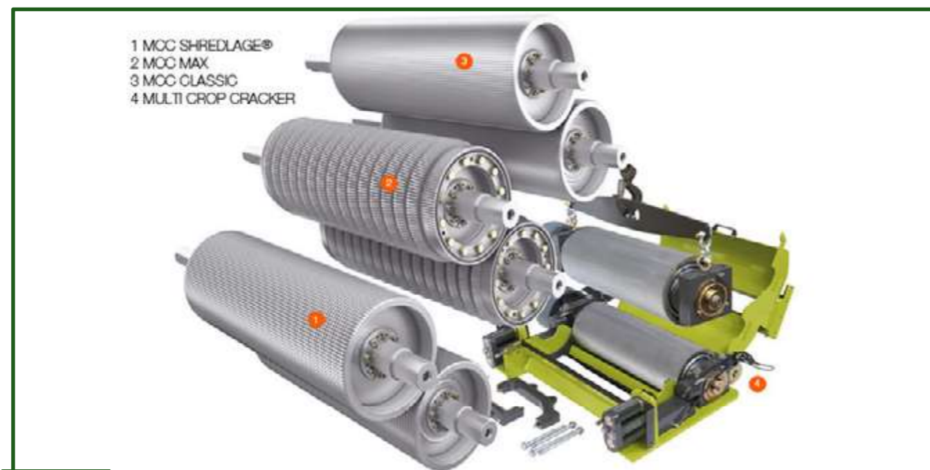
Figura 13-33 Gama de procesadores de grano con que se puede equipar las picadoras CLAAS Jaguar. 1: Multi Crop Cracker Shredlage que son rolos con un perfil de dientes de sierra con una ranura espiral que marcha en dirección opuesta y con una diferencia del régimen de revoluciones del 50 %. 2: Los rodillos MCC MAX han sido desarrollados para el acondicionamiento de ensilado de maíz con longitudes de corte entre 7 y 22 mm y está compuesto por 30 segmentos anulares perfilados en forma de dientes de sierra. La colocación y la especial geometría de los segmentos anulares hacen que el material sea trabajado no solo mediante un aplastamiento y fricción, sino también por fuerzas de corte y desgarrar. Esto permite un acondicionamiento más intensivo de los granos de maíz con endosperma cerosos y adicionalmente una abertura de las fibras del material de los tallos. 3: El convencional MCC CLASSIC está equipado con el acreditado perfil de dientes de sierra y trabaja de serie con una diferencia del régimen de revoluciones del 30 %. Este sistema es utilizado en picado de maíz con fibra de entre 14 y 20 mm y niveles de MS de ente 34 y 38 %. 4: versión MULTI CROP CRACKER específica para sorgo, que en el caso de Jaguar solo requiere cambiar un solo rodillo.
