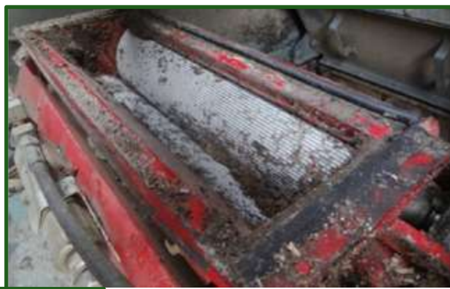
Figura 13-25 Vista general y parcial del cracker (con detalles de sus estrias) para cultivo de sorgo que utiliza la picadora Gomselmash FS80.
