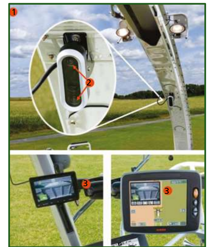
Figura 13-38 Sensor NIR HarvestLb que va ubicado en el codo de descarga de la jirafa de las picadoras John Deere 8000 y que mide en tiempo real MS, FDN, FDA, Proteína y Almidón. Este sensor se puede remover de la picadora y utilizarlo como una unidad fija en una oficina para medir no solo materiales recién picado, sino también silajes ya estabilizados.
