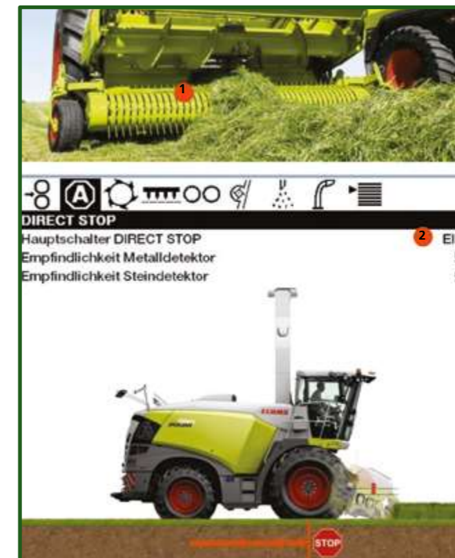
Figura 13-16 Detector de metales compuesto por 5 bobinas magnéticas (1) con sensibilidad ajustable de 1 a 5 (2) y que indica la localización en el monitor de la máquina (3). Al detectar el metal, requiere realizar una parada rápida para invertir el giro de la bomba hacia atrás (4).
