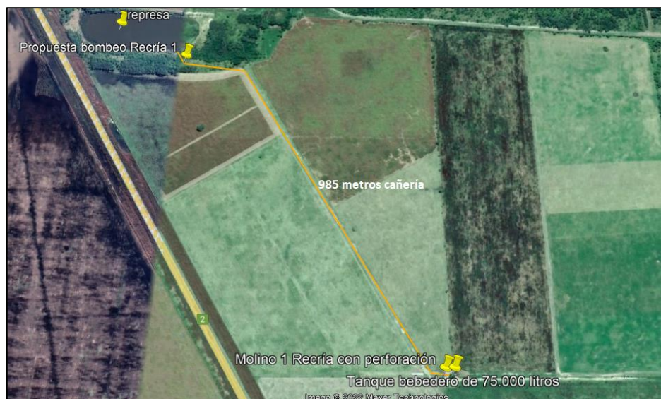
Imagen satelital con propuesta de bombeo desde represa hasta tanque bebedero.
