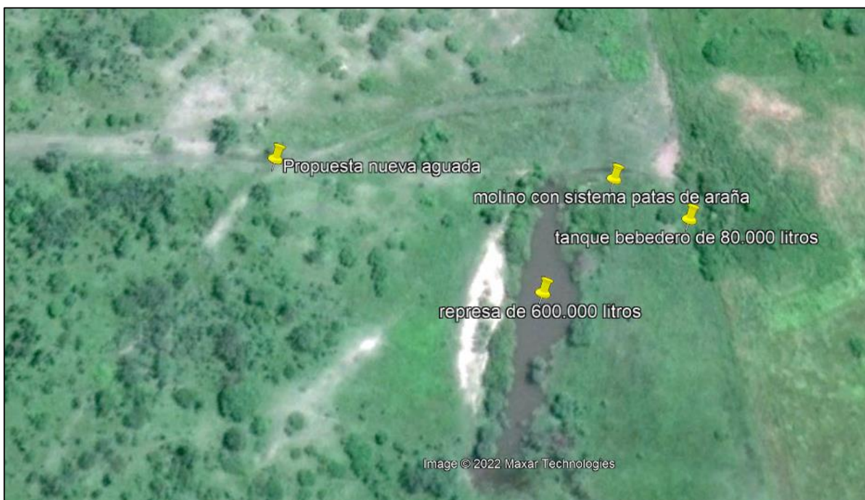
Imagen satelital de la aguada con represa y molino con sistema “patas de araña”
