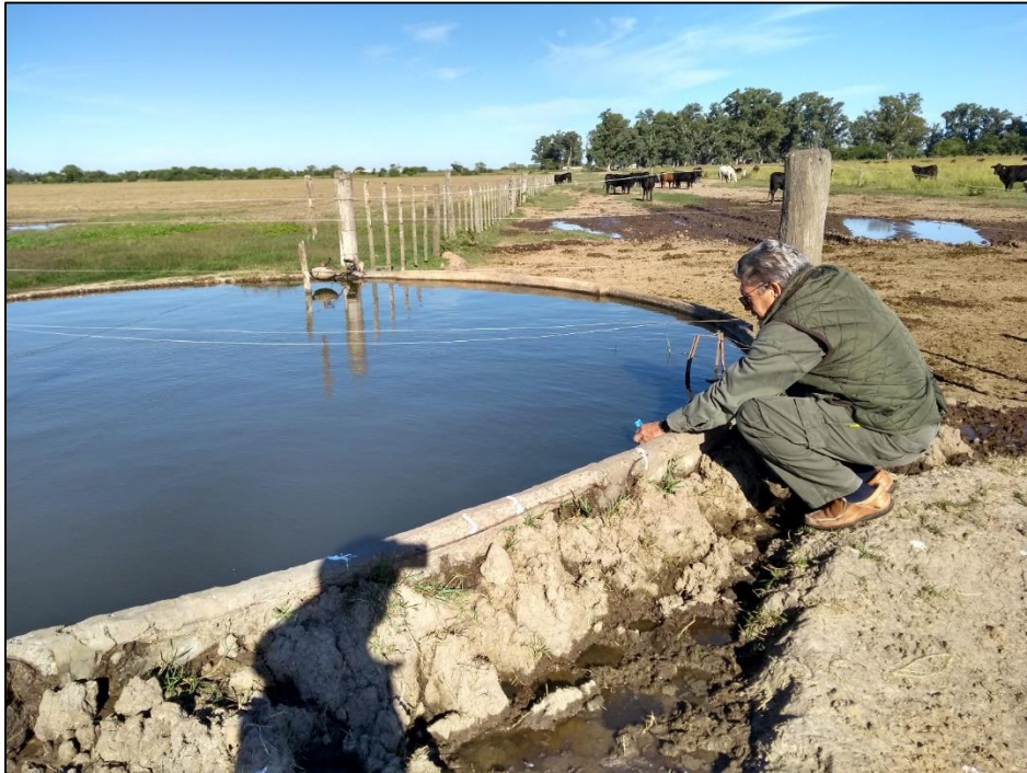
Midiendo la CE del agua en el tanque bebedero 1. Al fondo la forestación del Casco.
