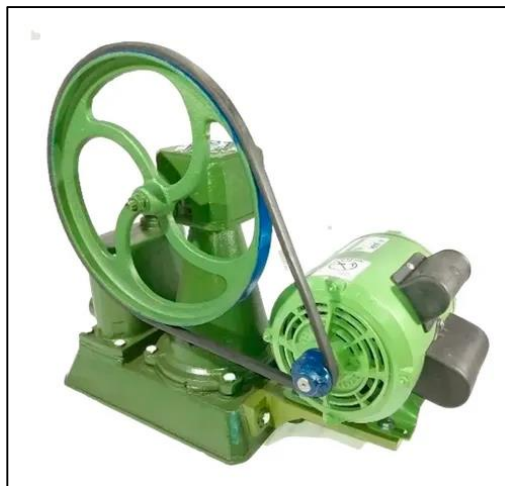
Bomba a diafragma con motor eléctrico accionado por energía solar.
