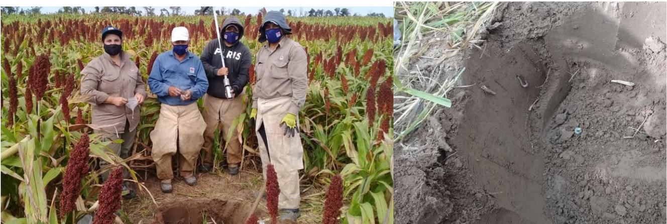
Figura 2. Muestreo de densidad aparente en distintas profundidades de cada bloque (foto izquierda). La presencia de lombrices es un síntoma de muy buena calidad de suelos (foto Muestreo 11 de marzo 2021)
