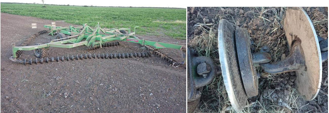
Figura 8: Rastra diamante y detalle de los discos encadenados.
