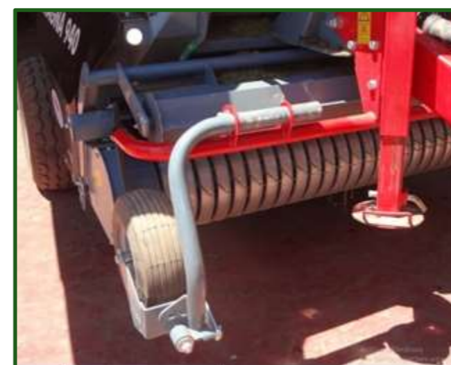
Figura 8-7 Rueda de copiado con regulación de altura ajustable, con un sistema de pernos (arriba). A su vez, en algunos modelos las ruedas pueden ser removidas para disminuir el ancho de transporte a 2,40m (abajo).
