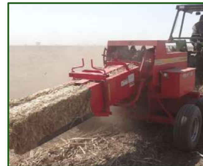
Figura 8-87 Proceso de confección del heno picado y embolsado.
