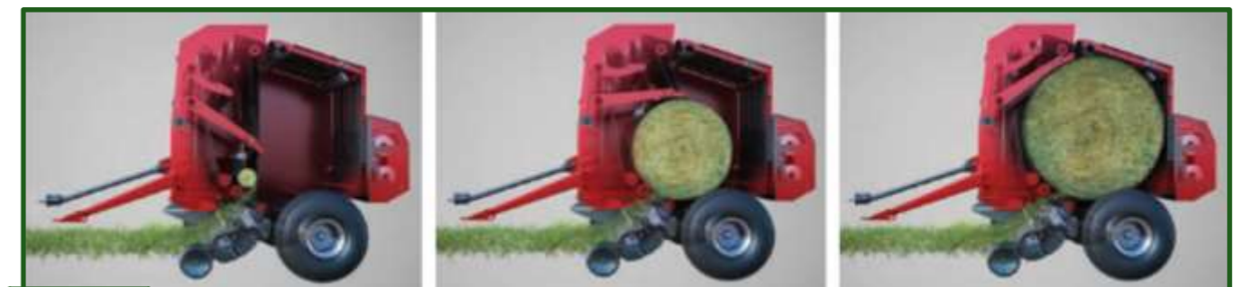
Figura 8-15 Esquema que muestra el proceso de alimentación y formación del rollo, en una máquina garganta vertical de cámara variable.
