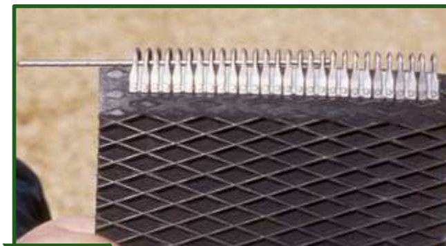
Figura 8-27 Unión de correa flexible que aumentan la vida útil (arriba) y perno acerado de las uniones de correas que les permiten mayor flexibilidad (abajo).
