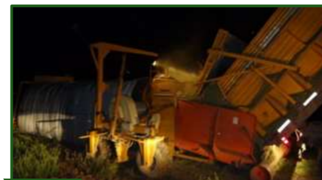
Figura 8-91 Material picado depositado en camión volcador descargado a la embolsadora modificada.
