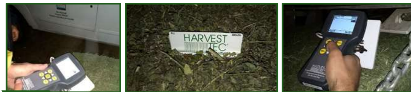
Figura 8-79 Etiqueta Sistema Harvest Tec colocado en uno de los hilos de atado, que permite dejar trazado el heno en un microchip de radiofrecuencia.
