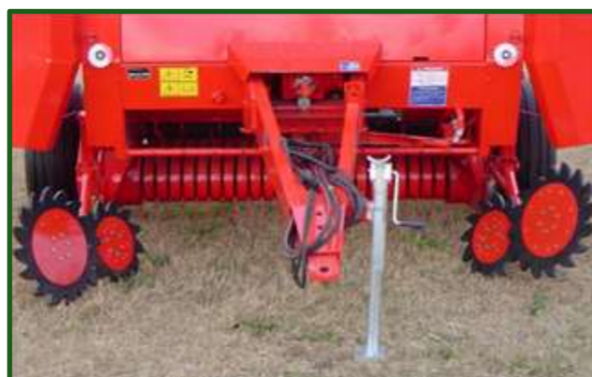
Figura 8-5 Ruedas de alimentación lateral en máquinas con recolector de igual ancho que la cámara de compactación.
