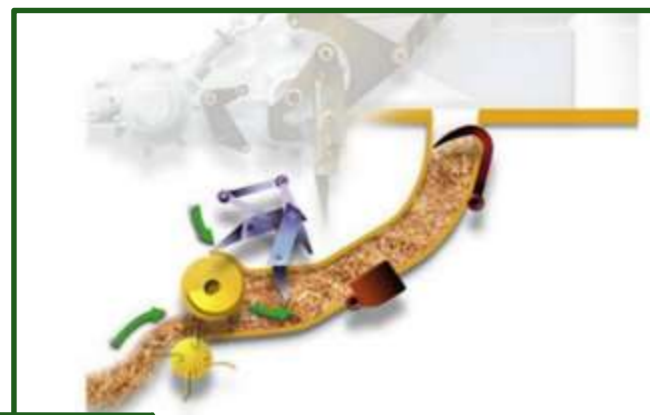
Figura 8-59 Detalle de alimentador a horquillas utilizado en versiones sin procesador de fibra.
