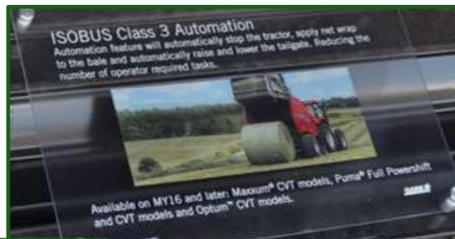
Figura 8-25 En el Farm Progress Show 2017 Case IH lanzó la serie RB5 con tecnología de automatización de tractor habilitada para ISOBUS Clase 3, que detiene automáticamente el tractor cuando se alcanza el tamaño de rollo objetivo.
