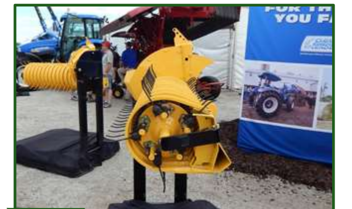
Figura 8-58 Recolector de megaenfordadora equipados con dedos curvos.
