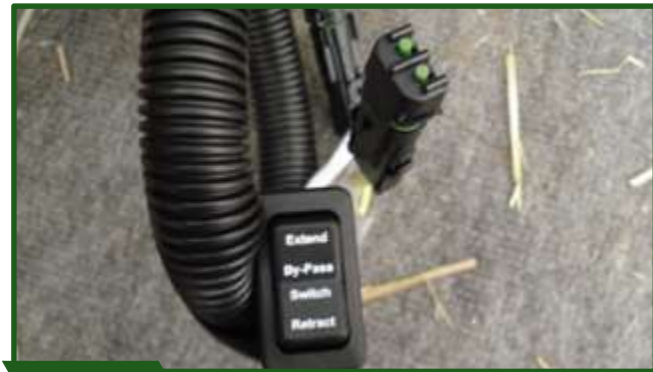
Figura 8-17 Ficha de By Pass o puente hacia el sistema eléctrico para trabajar sin necesidad del atador.
