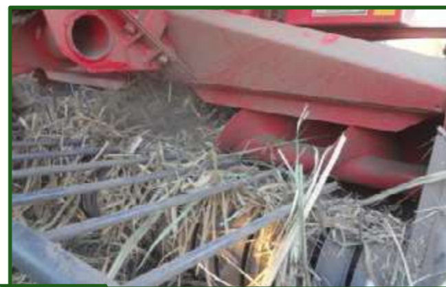
Figura 8-84 Detalle del recolector de enfardadora (arriba) y material conducido al centro de la máquina (abajo).
