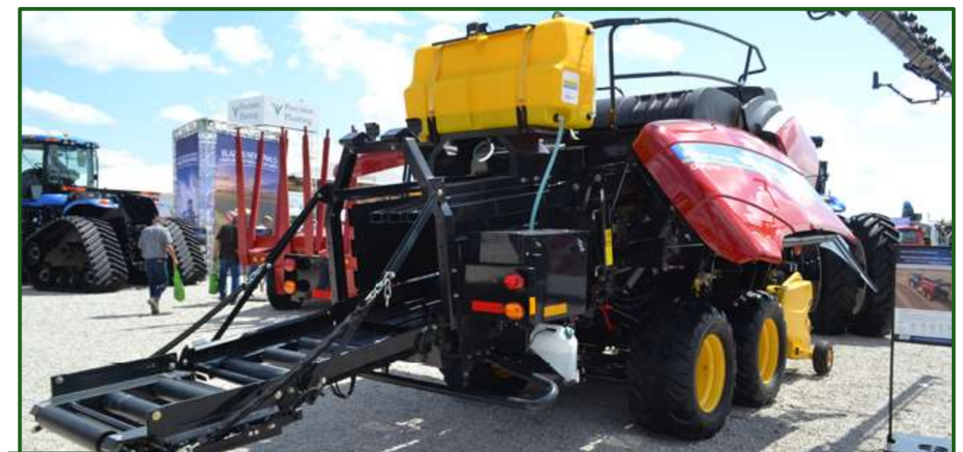
Figura 8-75 Megaenfardadora equipada con sistema "Crop Saver buffered acid" y balanza.
