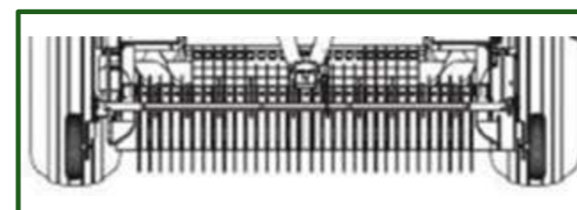
Figura 8-8 Esquema de recolector con ruedas limitadoras de profundidad.
