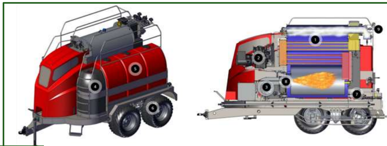
Figura 8-81 Componentes de la humidificadora. 1 caldera, 2: generador diésel, 3: quemador, 4: tanque de gasoil, 5: tanque de agua, 6: neumáticos, 7: sistema de alimentación de agua, 8: calentador alimentado a propano, 9: mangueras.
