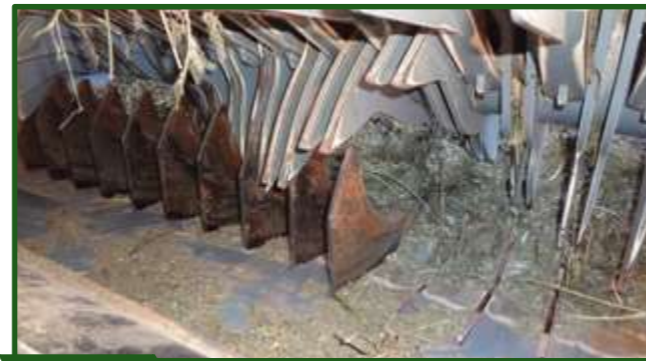
Figura 8-41 Arriba: rotor alimentador compuesto por estrellas de distribución helicoidal. Abajo: detalle de las cuchillas dispuestas en la parte inferior del rotor.
