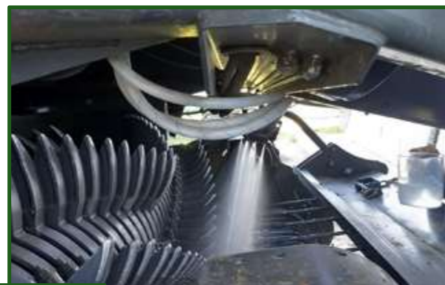
Figura 8-78 Detalle del tanque de líquido (arriba) y barra con picos y pastillas (abajo).
