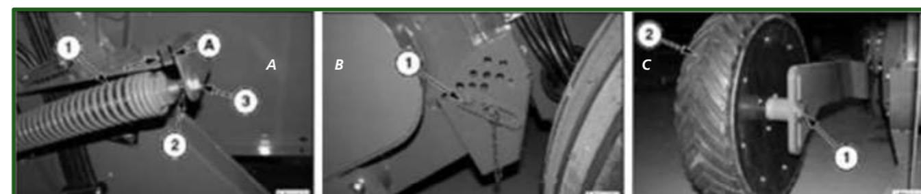
Figura 8-9 A: resorte de flotación. B: regulación de altura del recolector. C: regulación de rueda limitadora de profundidad.
