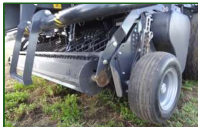
Figura 8-2 Rodillo flotante de pre-compresión del forraje que mejora las condiciones de recolección.
