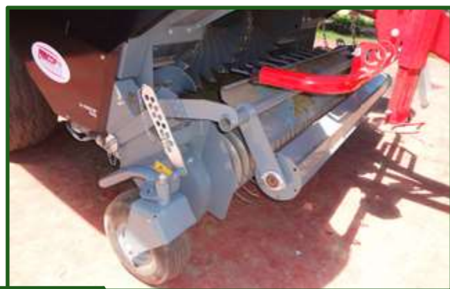
Figura 8-2 Rodillo flotante de pre-compresión del forraje que mejora las condiciones de recolección.
