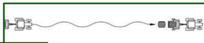
Figura 8-55 Conducción inadecuada en la formación del rollo.
