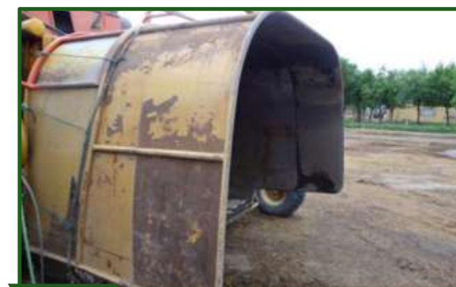
Figura 8-92 Embolsadora con túnel de 9 pies de ancho, peine longitudinal, rampa a cinta de lona y motor Deutz de 160 hp.
