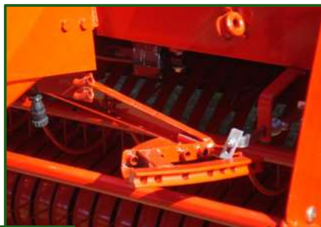
Figura 8-29 Detalle de sistema de brazo simple con doble aguja (arriba) y brazo simple con 4 u 8 salidas (abajo).
