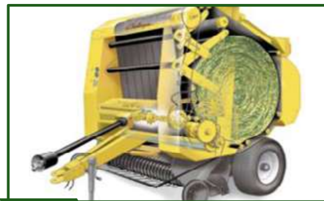
Figura 8-13 Izquierda: Rotoenfardadora de cámara variable garganta vertical abierta (diseño americano). Derecha: Rotoenfardadora de cámara variable y garganta longitudinal (diseño europeo).
