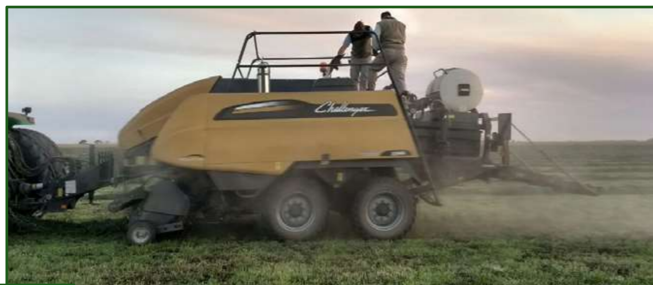
Figura 8-77 Megaenfardadora Challenger equipada con dosificador Hay Boss2.
