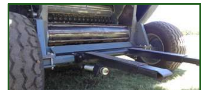
Figura 8-39 Pateador expulsor (arriba) y rampa de descarga de los rollos (abajo).
