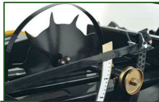
Figura 8-67 Rueda dentada que mide los movimientos del megafardo dentro de la cámara.
