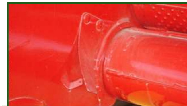
Figura 8-16 Palpadores (sensores) externo e interno de llenado de la cámara de compactación en diferentes máquinas.
