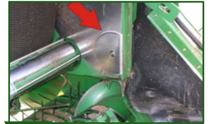
Figura 8-49 Sensor de humedad incorporado en la cámara de compactación de la rotoenfardadora.
