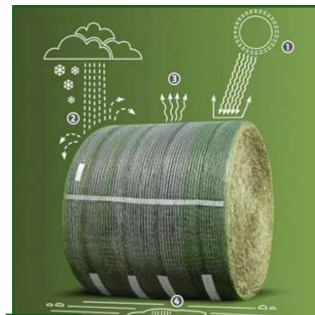
Figura 8-38 El sistema de atado B-Wrap brinda protección contra daños por radiación UV (1), resistencia al ingreso de agua de lluvia o nieve (2), evita que ingrese humedad que el suelo puede transferirle por evaporación (4) y a su vez posee poros microscópicos que permiten que el vapor de agua, dentro de la paca, escape (3).
