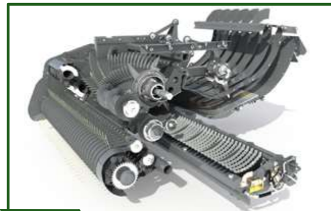
Figura 8-61 Rotor alimentador en las versiones CropCutter y detalle del cajón con cuchillas que se dispone en el piso del alimentador para producir el corte por cizalla. Este cajón es removible.
