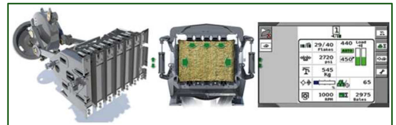
Figura 8-64 Izquierda: detalle de pistón de acero (AGCO Corporation, 2011); Derecha: Los cilindros hidráulicos de densidad de doble efecto aplican presión a ambos lados y a la parte superior de la cámara para proporcionar a las placas una densidad homogénea, todo ello controlado de forma automática a través del monitor de la megaenfardadora.
