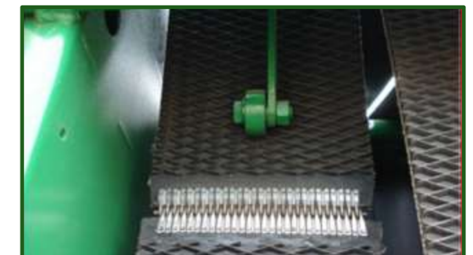
Figura 8-16 Palpadores (sensores) externo e interno de llenado de la cámara de compactación en diferentes máquinas.
