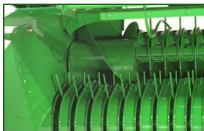
Figura 8-3 Recolector más ancho que la cámara de compactación.
