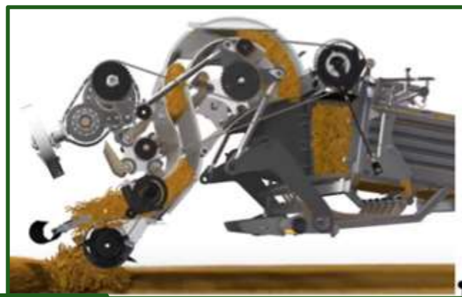
Figura 8-65 Detalle del sistema de alimentación y compactación del modelo Cicoria comercializado por Yomel.
