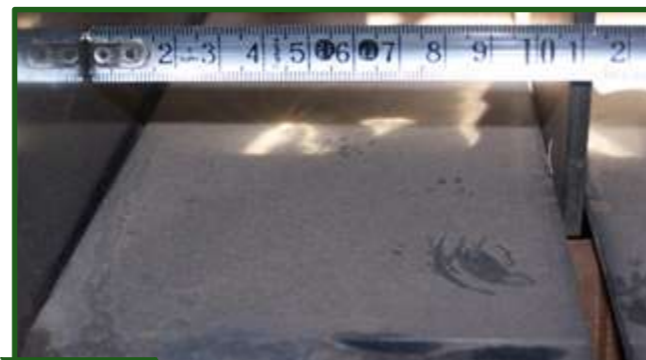
Figura 8-42 Detalle del piso del rotor donde se pueden colocar cuchillas cada 7 cm (arriba) dejando 11 cm en los laterales, entre la última cuchilla y la pared de la cámara (abajo).
