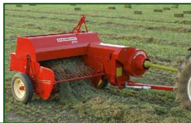
Figura 8-82 Enfardadora de fardos prismáticos de 25 kg.
