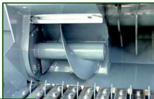
Figura 8-4 Detalle de distintos modelos de sinfín de alimentación lateral de recolector ancho.
