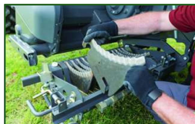
Figura 8-62 Detalle de cuchilla dentada semicircular similar a la utilizada en rotoenfardadoras.
