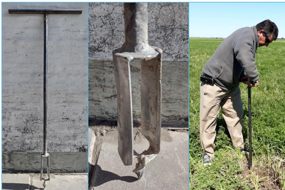
**Figura 5.** Barreno helicoidal y perforación del suelo para la instalación del freaímetro.
