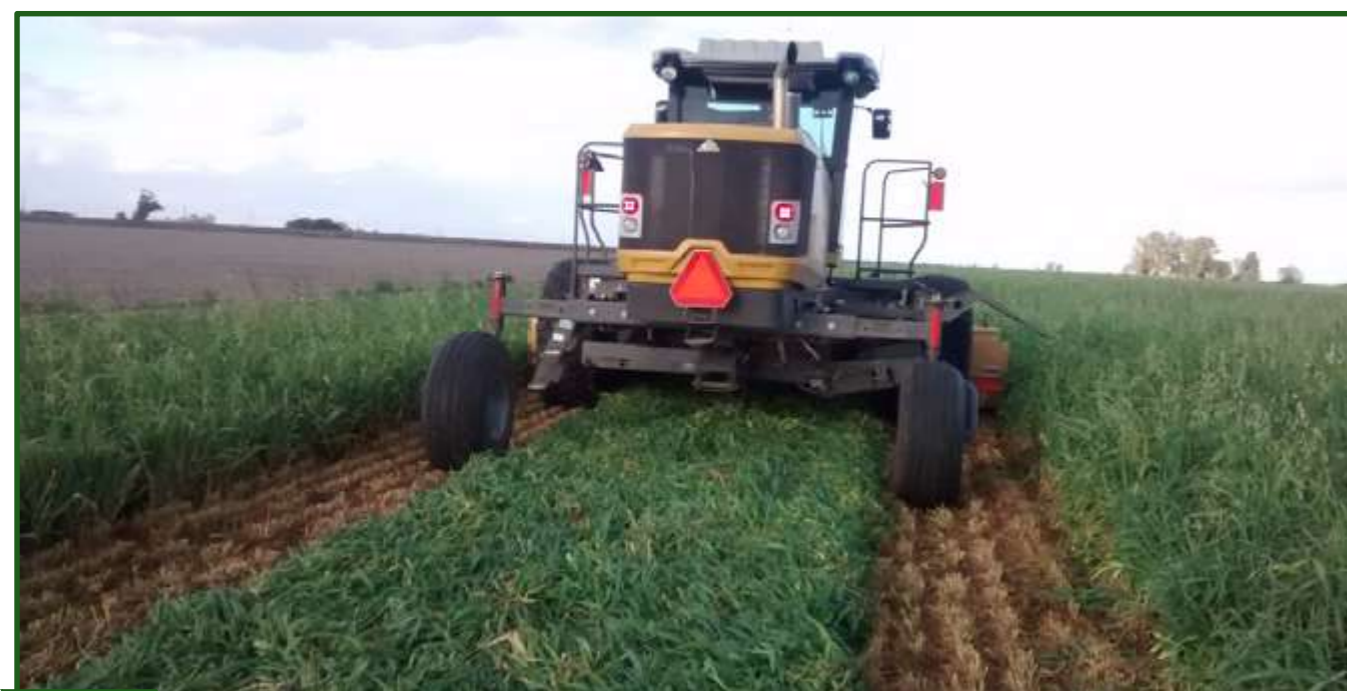
Figura 4-16 En la actualidad se encuentra más justificada la incorporación de máquinas de corta hilerado con acondicionador de mayor ancho de corte.
