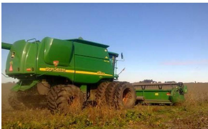
**Figura 13.** Cosechadora equipada con neumáticos triales.
